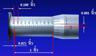
การแบ่งสเกลไมโครมิเตอร์วัดนอกค่าความละเอียด 0.001 นิ้ว
