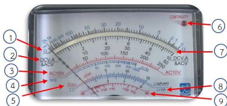
รูปที่ 1.2 รายละเอียดหน้าจอสเกลอ่านค่าของมัลติมิเตอร์แอนะล็อก
