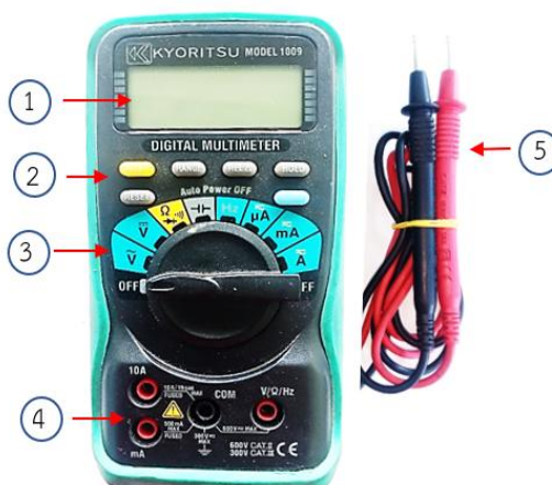
รูปที่ 1.9 ส่วนประกอบของมัลติมิเตอร์ดิจิทัล
