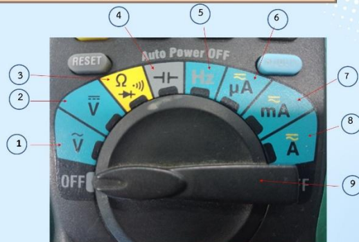
รูปที่ 1.20 สัญลักษณ์และสวิตช์เลือกเมนูการวัดค่าต่างๆ ของมัลติมิเตอร์ดิจิทัล
