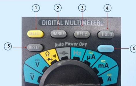
รูปที่ 1.21 ปุ่มปรับเลือกการวัดค่าต่าง ๆ ของมัลติมิเตอร์ดิจิทัล
