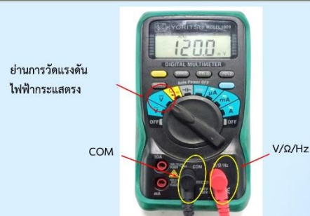
รูปที่ 1.23 การปรับสวิตช์เลือกย่านการวัดแรงดันไฟฟ้ากระแสตรง (DCV) ของมัลติมิเตอร์ดิจิทัล
