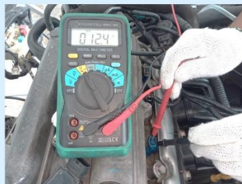
รูปที่ 1.33 การใช้มัลติมิเตอร์ดิจิทัลวัดความต้านทานของอุปกรณ์ในรถยนต์
