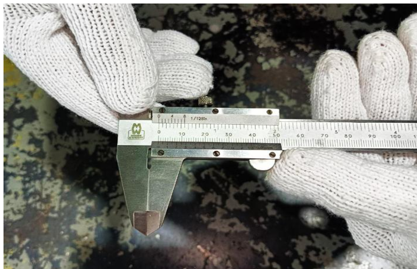
ภาพที่ 3.9 การทำความสะอาดและตรวจสอบความเที่ยงตรงของเวอร์เนียคาลิปเปอร์ (ที่มา : เดช ทองแก้ว, 2567)
