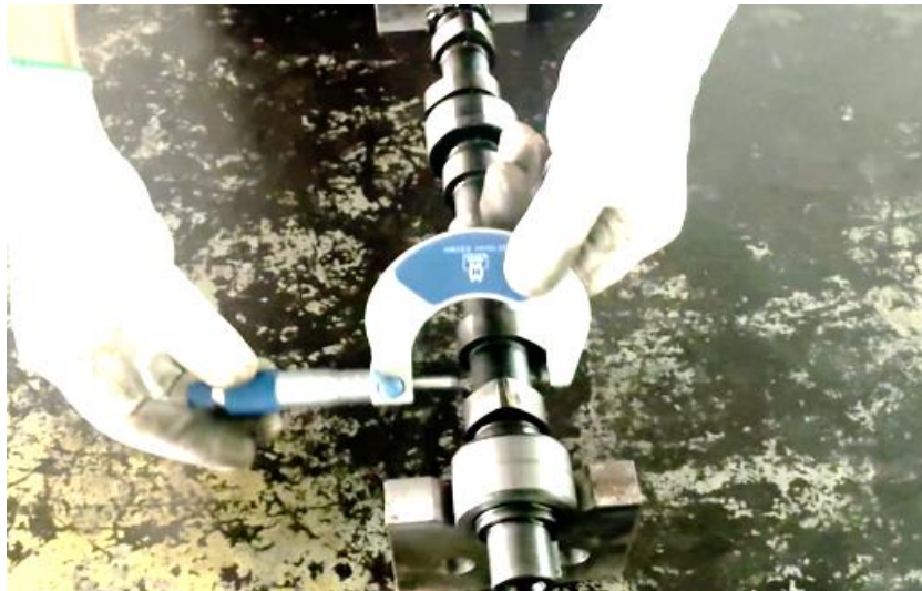
ภาพที่ 3.15 การตรวจวัดความโตของลูกเบี้ยวไอดีสูบที่ 1 (ที่มา : เดช ทองแก้ว, 2567)
