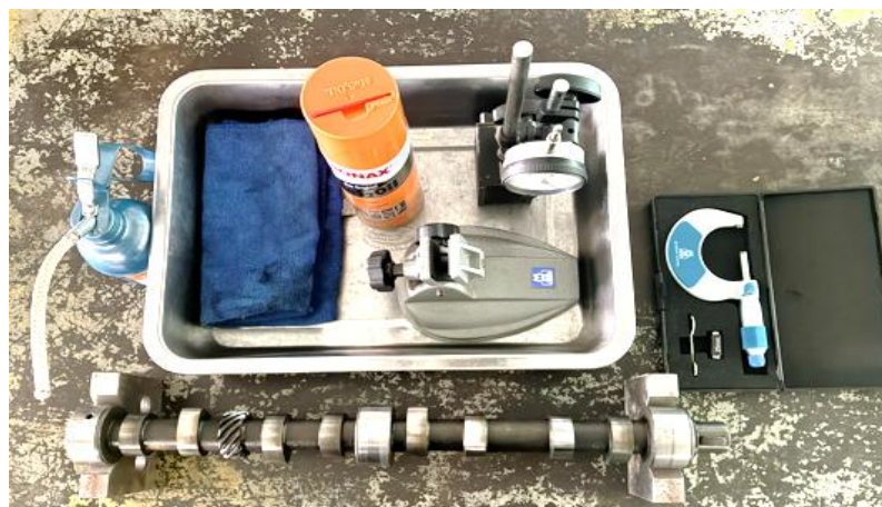
ภาพที่ 3.7 ชิ้นส่วนเครื่องยนต์ เครื่องมือวัดละเอียด และอุปกรณ์ในการปฏิบัติงานตรวจวัดการสึกหรอของลูกเบี้ยวและการคดของเพลาลูกเบี้ยวเครื่องยนต์ (ที่มา : เดช ทองแก้ว, 2567)
