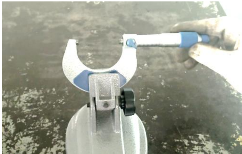
ภาพที่ 3.36 การปรับตั้งค่าไมโครมิเตอร์ให้ได้ระยะวัดเท่ากับหรือใกล้เคียงค่าความโตของเพลาลูกเบี้ยว (ที่มา : เดช ทองแก้ว, 2567)
