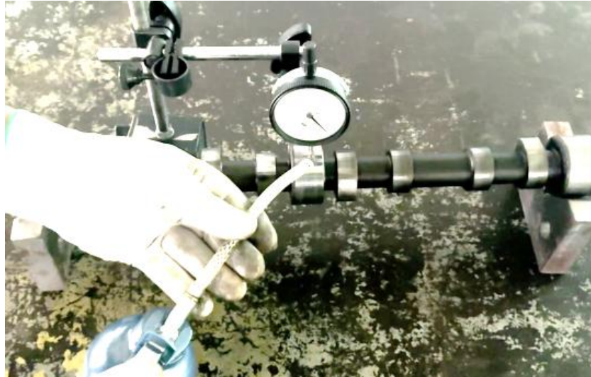
ภาพที่ 3.22 การหล่อลื่นจุดสัมผัสจุดตรวจวัดการคดของเพลาลูกเบี้ยวเครื่องยนต์ (ที่มา : เดช ทองแก้ว, 2567)
