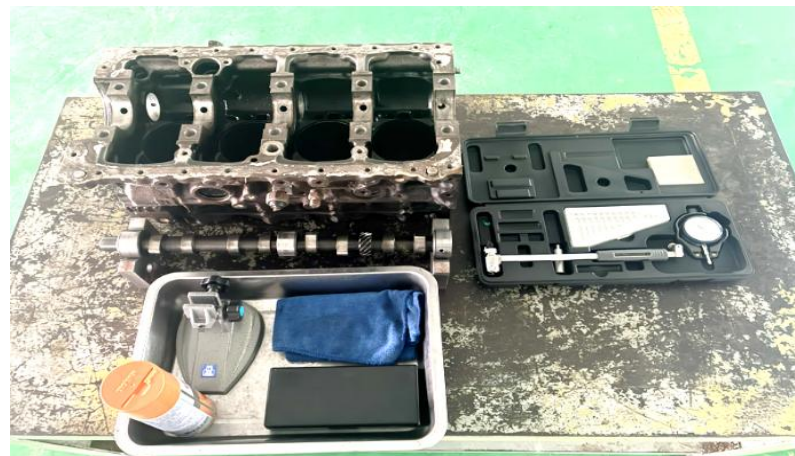
ภาพที่ 3.28 เครื่องมือวัดละเอียด วัสดุ และอุปกรณ์ในการปฏิบัติงานตรวจวัดระยะห่างบูชเพลาลูกเบี้ยวกับเพลาลูกเบี้ยวเครื่องยนต์ (ที่มา : เดช ทองแก้ว, 2567)
