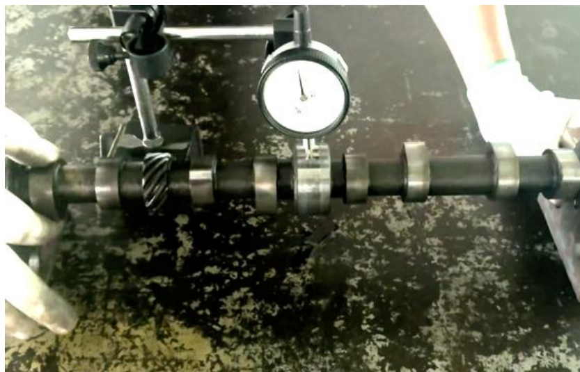
ภาพที่ 3.23 การอ่านค่าการคดของเพลาลูกเบี้ยวเครื่องยนต์จากนาฬิกาวัด (ที่มา : เดช ทองแก้ว, 2567)
