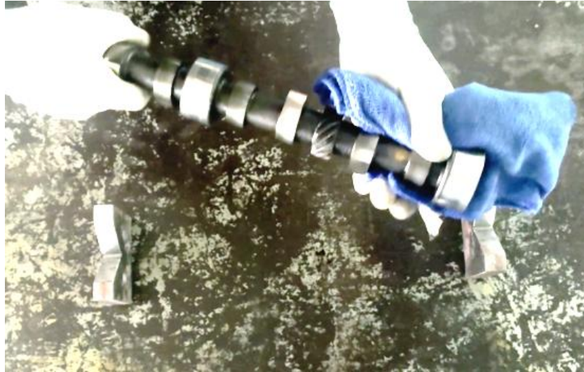
ภาพที่ 3.8 การทำความสะอาดเพลาลูกเบี้ยวเครื่องยนต์ (ที่มา : เดช ทองแก้ว, 2567)
