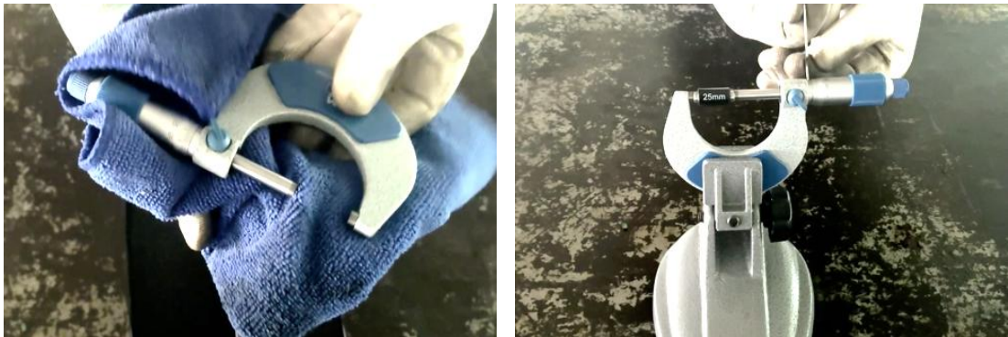
ภาพที่ 3.34 การทำความสะอาดและตรวจสอบความเที่ยงตรงของไมโครมิเตอร์วัดนอก (ที่มา : เดช ทองแก้ว, 2567)
