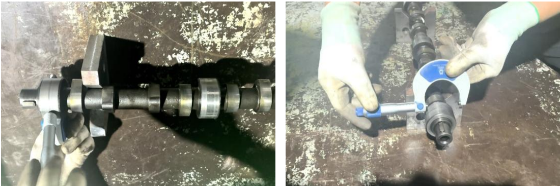
ภาพที่ 3.44 การตรวจวัดความโตของเพลาลูกเบี้ยวข้อหน้า (ที่มา : เดช ทองแก้ว, 2567)
