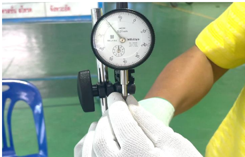
ภาพที่ 3.13 การทำความสะอาดและตรวจสอบความเที่ยงตรงของนาฬิกาวัด (ที่มา : เดช ทองแก้ว, 2567)
