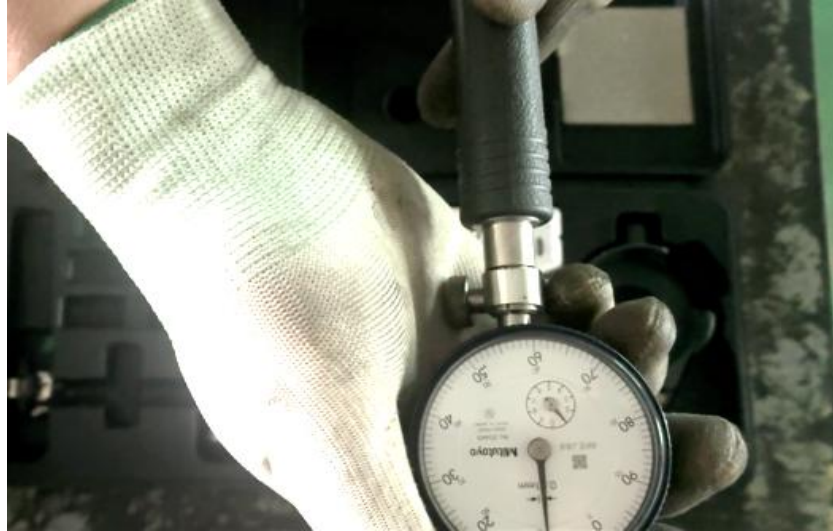
ภาพที่ 3.37 การประกอบเกจวัดกระบอกสูบเพื่อตรวจวัดความโตบุงเพลาลูกเบี้ยว (ที่มา : เดช ทองแก้ว, 2567)
