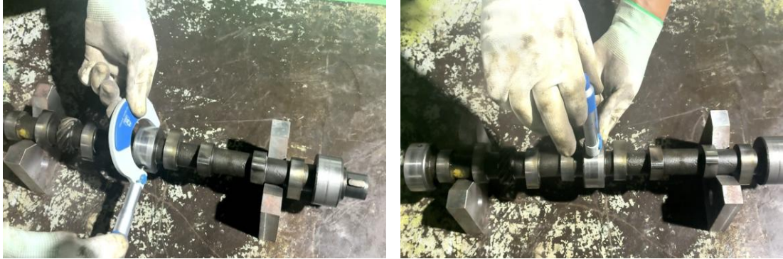
ภาพที่ 3.45 การตรวจวัดความโตข้อเพลาลูกเบี้ยวข้อกลาง (ที่มา : เดช ทองแก้ว, 2567)
