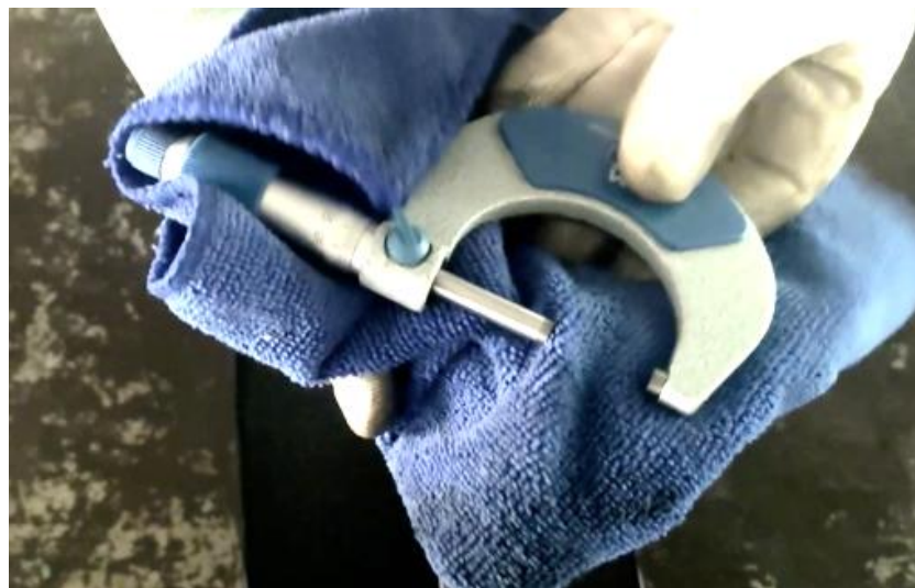
ภาพที่ 3.11 การทำความสะอาดไมโครมิเตอร์วัดนอก (ที่มา : เดช ทองแก้ว, 2567)
