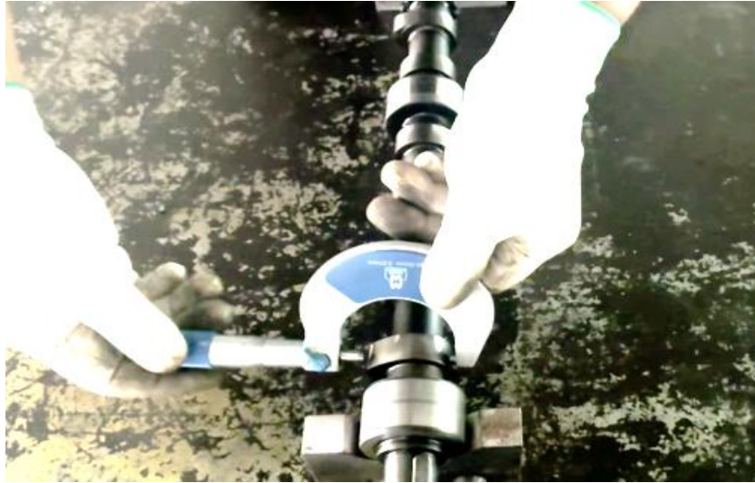
ภาพที่ 3.14 การตรวจวัดความสูงของลูกเบี้ยวไอดีสูบที่ 1 (ที่มา : เดช ทองแก้ว, 2567)
