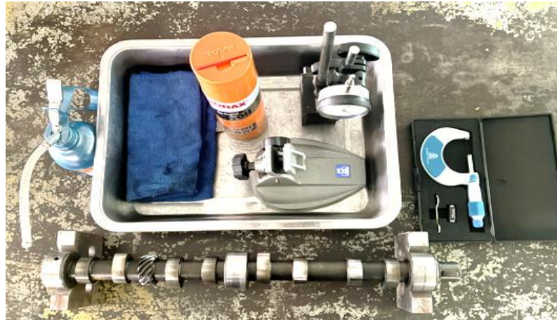
ภาพที่ 3.6 เครื่องมือวัดละเอียด วัสดุ และอุปกรณ์ในการปฏิบัติงานตรวจวัดการสึกหรอของลูกเบี้ยวและการคดของเพลาลูกเบี้ยวเครื่องยนต์ (ที่มา : เดช ทองแก้ว, 2567)
