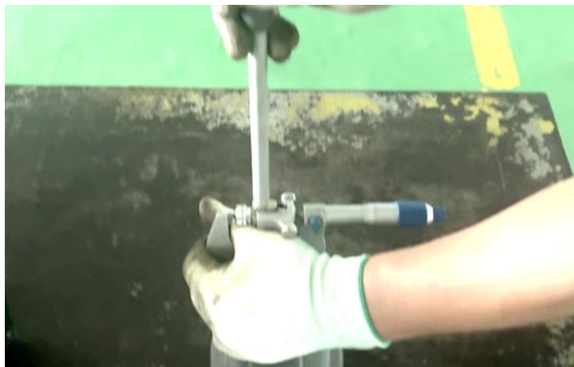
ภาพที่ 3.38 การติดตั้งเกจวัดกระบอกสูบในไมโครมิเตอร์วัดนอกเพื่อปรับตั้งค่าให้เท่ากัน (ที่มา : เดช ทองแก้ว, 2567)
