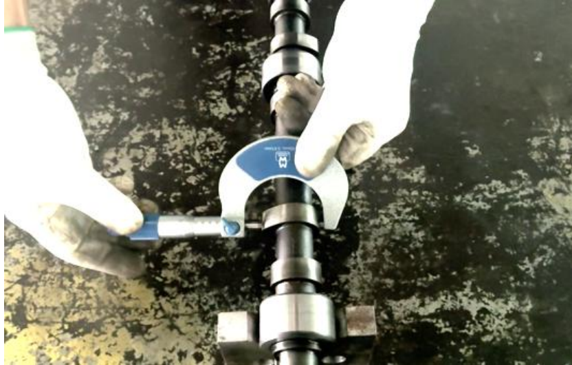
ภาพที่ 3.16 การตรวจวัดความสูงของลูกเบี้ยวไอดีสูบที่ 1 (ที่มา : เดช ทองแก้ว, 2567)
