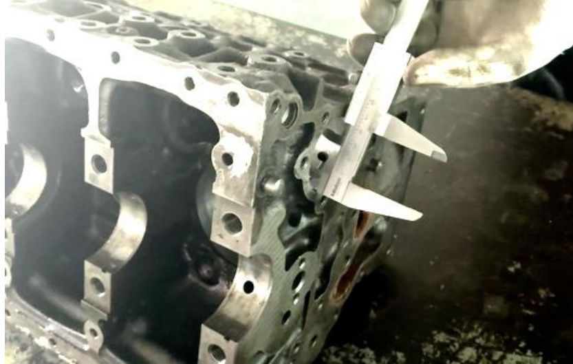
ภาพที่ 3.33 การตรวจวัดขนาดเบื้องต้นของบูชเพลาลูกเบี้ยว (ที่มา : เดช ทองแก้ว, 2567)
