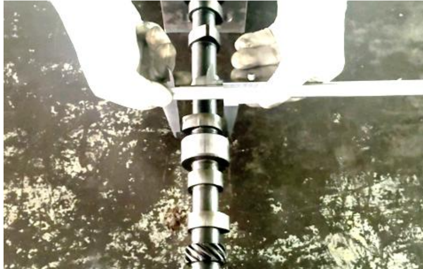
ภาพที่ 3.10 การตรวจวัดความสูงลูกเบี้ยวและความโตลูกเบี้ยวเบื้องต้นด้วยเวอร์เนียคาลิปเปอร์ (ที่มา : เดช ทองแก้ว, 2567)
