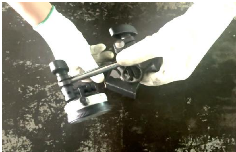
ภาพที่ 3.19 การติดตั้งนาฬิกาวัดเข้ากับชุดแขนยึดในแท่นยึดนาฬิกาวัด (ที่มา : เดช ทองแก้ว, 2567)
