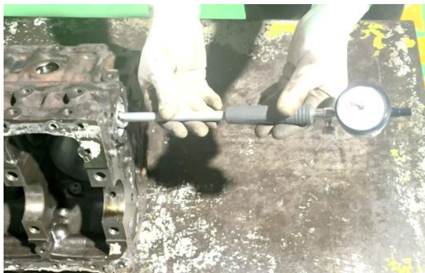
ภาพที่ 3.40 การตรวจวัดความโตบวมเพลาลูกเบี้ยวตัวหน้าของเสื้อสูบเครื่องยนต์ (ที่มา : เดช ทองแก้ว, 2567)
