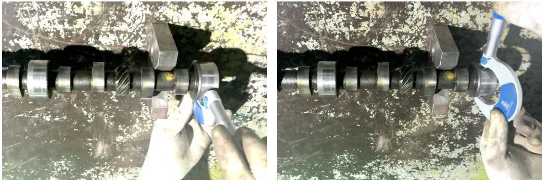
ภาพที่ 3.46 การตรวจวัดความโตข้อเพลาลูกเบี้ยวข้อหลัง (ที่มา : เดช ทองแก้ว, 2567)
