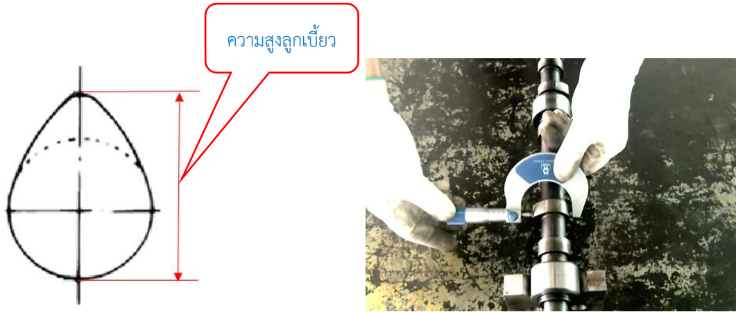
ภาพที่ 3.2 การตรวจวัดความสูงลูกเบี้ยวเครื่องยนต์ (ที่มา : เดช ทองแก้ว, 2567)
