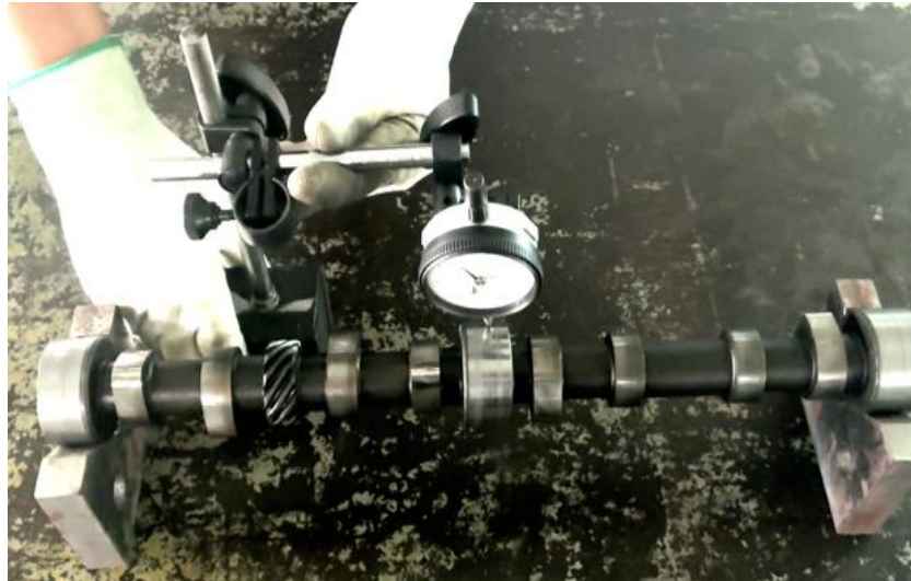
ภาพที่ 3.20 การติดตั้งนาฬิกาวัดเพื่อตรวจวัดการคดของเพลาลูกเบี้ยวเครื่องยนต์ (ที่มา : เดช ทองแก้ว, 2567)
