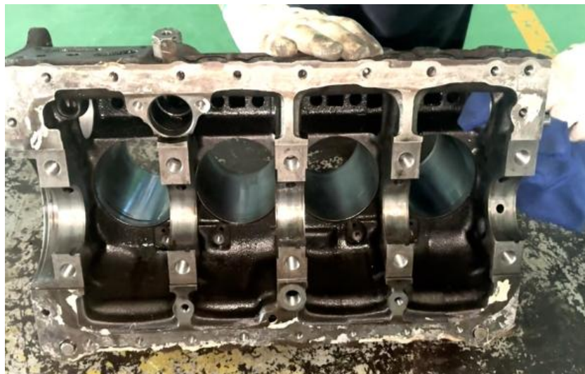
ภาพที่ 3.30 การทำความสะอาดบุชเพลาลูกเบี้ยวเครื่องยนต์ (ที่มา : เดช ทองแก้ว, 2567)
