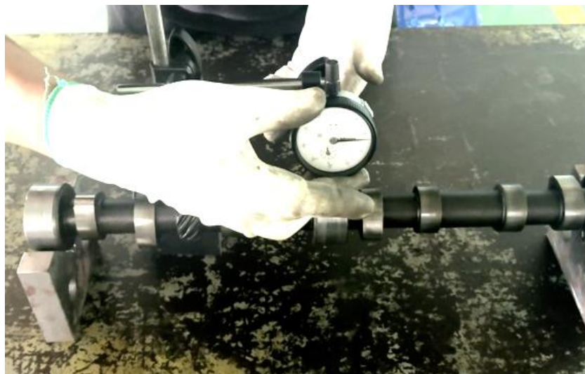
ภาพที่ 3.21 การปรับนาฬิกาวัดก่อนตรวจวัดการคดของเพลาลูกเบี้ยวเครื่องยนต์ (ที่มา : เดช ทองแก้ว, 2567)
