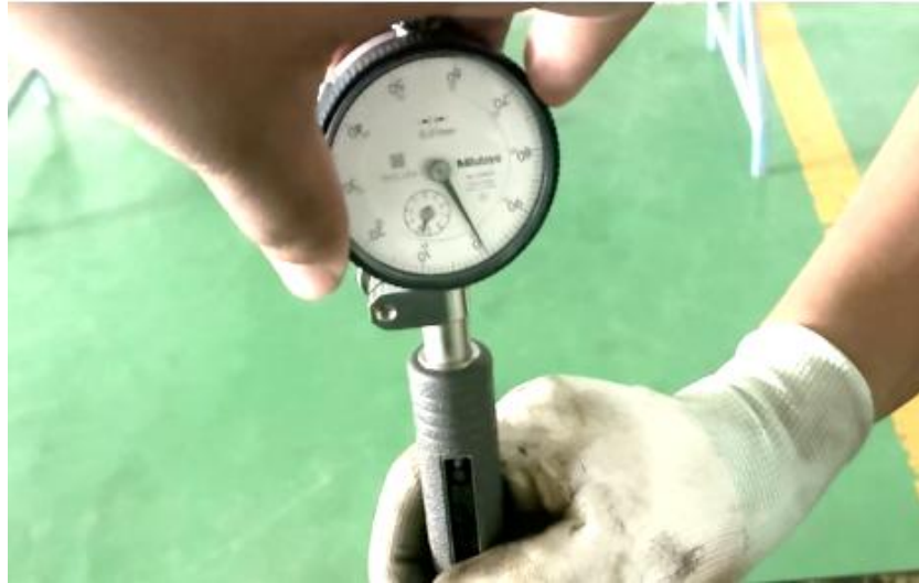
ภาพที่ 3.39 การปรับเกจหน้าปิดเกจวัดกระบอกสูบให้เข็มยาวตรงกับสเกล “0” เพื่อให้ขนาด เกจวัดกระบอกสูบมีค่าเท่ากับไมโครมิเตอร์ (ที่มา : เดช ทองแก้ว, 2567)
