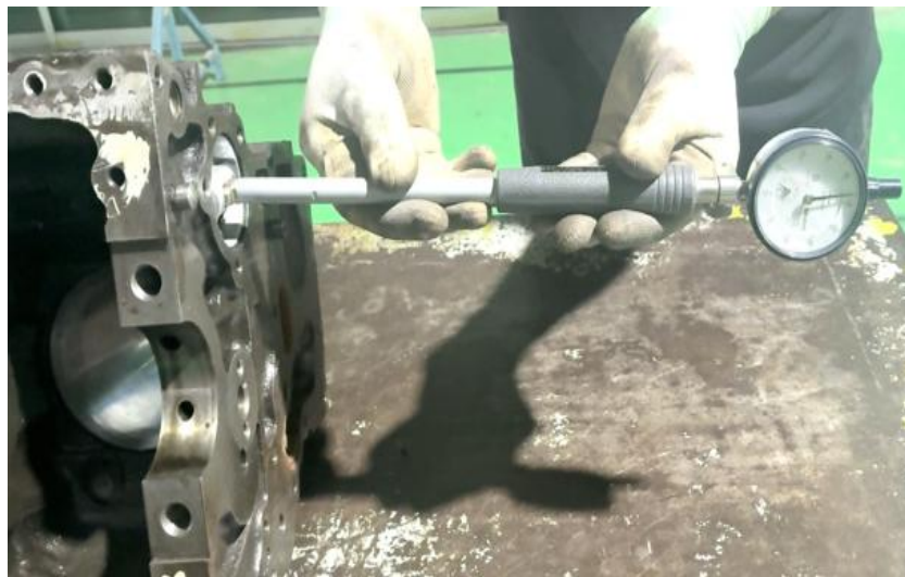
ภาพที่ 3.42 การตรวจวัดความโตของเพลาลูกเบี้ยวตัวหน้าของเสื้อสูบเครื่องยนต์แนวที่ 2 (ที่มา : เดช ทองแก้ว, 2567)
