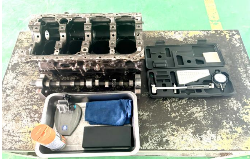
ภาพที่ 3.29 ชิ้นส่วนเครื่องยนต์ เครื่องมือวัดละเอียด และอุปกรณ์ในการปฏิบัติงานตรวจวัดระยะห่างบุชเพลาลูกเบี้ยวกับเพลาลูกเบี้ยวเครื่องยนต์ (ที่มา : เดช ทองแก้ว, 2567)
