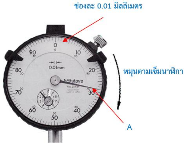
ภาพที่ 3.41 การอ่านค่าความโตของเพลาลูกเบี้ยวจากหน้าปัดเกจวัดกระบอกสูบ (ที่มา : เดช ทองแก้ว, 2567)
