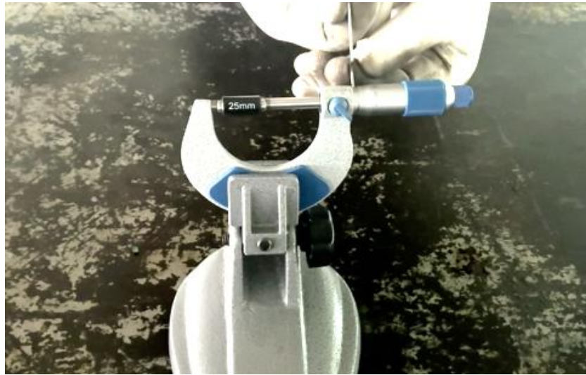
ภาพที่ 3.12 การปรับและตรวจสอบความเที่ยงตรงของไมโครมิเตอร์วัดนอก (ที่มา : เดช ทองแก้ว, 2567)
