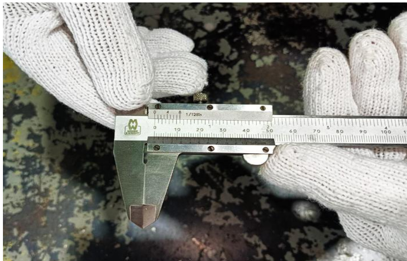
ภาพที่ 3.32 การทำความสะอาดและตรวจสอบความเที่ยงตรงของเวอร์เนียคาลิปเปอร์ (ที่มา : เดช ทองแก้ว, 2567)
