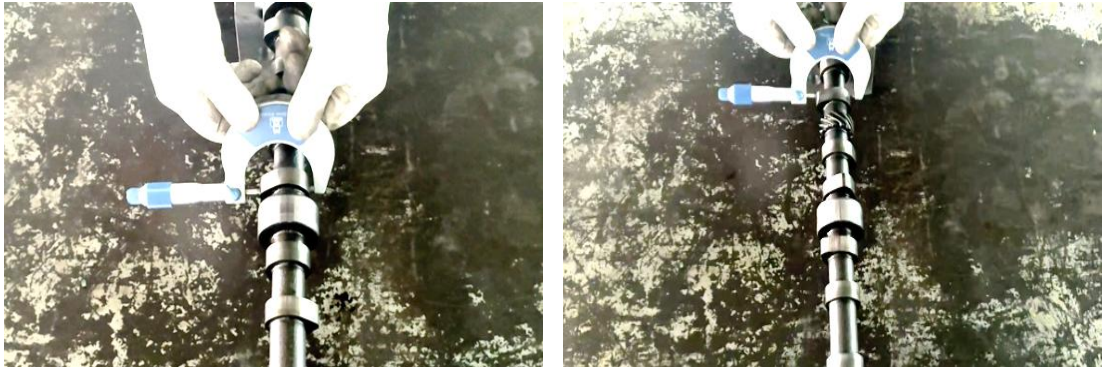
ภาพที่ 3.18 การตรวจวัดความสูงและความโตของลูกเบี้ยวไอดีและไอเสียสูบที่ 2, 3 และ 4 (ที่มา : เดช ทองแก้ว, 2567)
