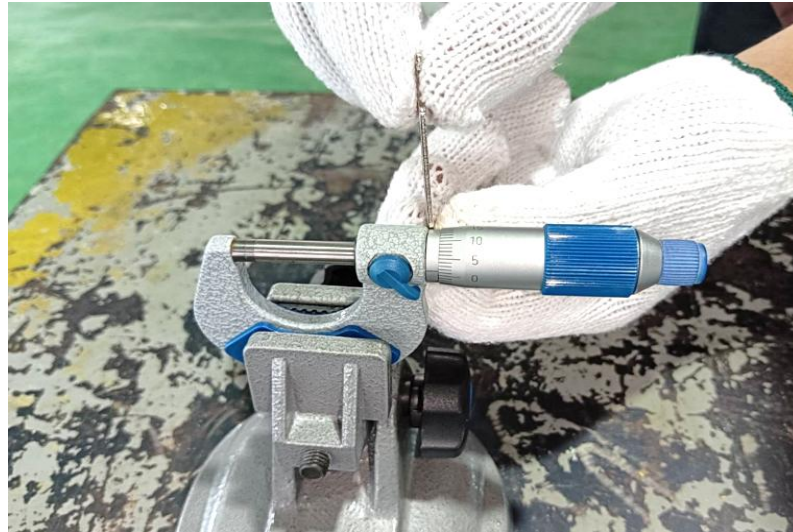
ภาพที่ 1.54 การปรับและตรวจสอบความเที่ยงตรงของไมโครมิเตอร์วัดนอก (ที่มา : เดช ทองแก้ว, 2567)
