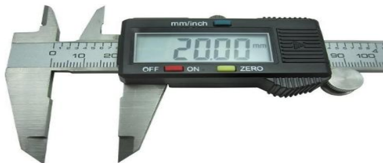
ภาพที่ 1.26 เวอร์เนอร์คาลิปเปอร์แบบดิจิตอล (ที่มา : เดช ทองแก้ว, 2567)
