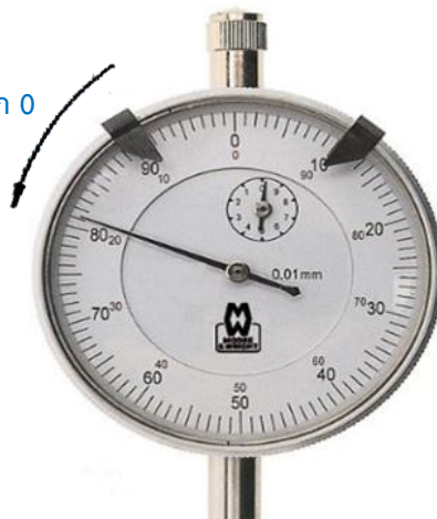
ภาพที่ 1.75 เข็มยาวเกจวัดกระบอกสูบ ทวนเข็มนาฬิกาจากซีดสเกล “0” (ที่มา : เดช ทองแก้ว, 2567)
