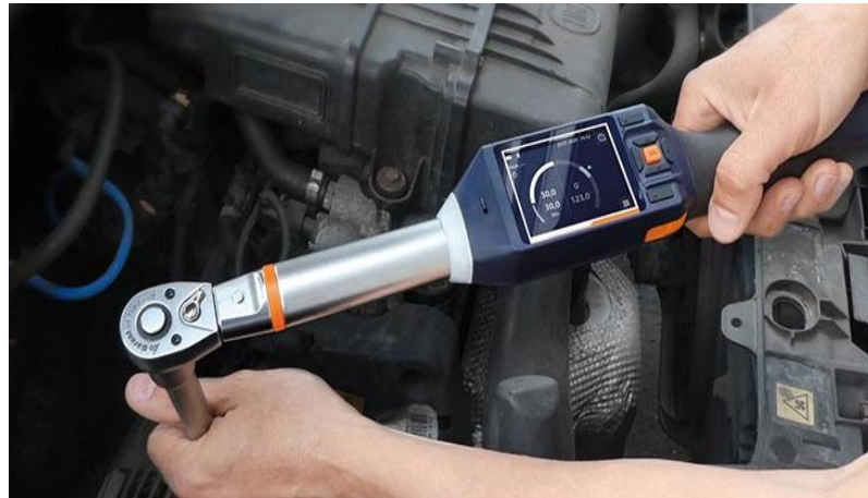
ภาพที่ 1.63 การขันโบลท์ด้วยประแจวัดแรงบิดแบบดิจิทัล (ที่มา : https://hmgrouphailand.com , สืบค้น 20 พฤษภาคม 2567)
