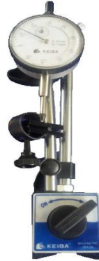
ภาพที่ 1.35 นาฬิกาวัดพร้อมแท่นแม่เหล็ก (ที่มา : เดช ทองแก้ว, 2567)
