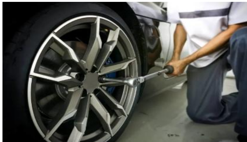
ภาพที่ 1.64 การขันโบลท์ด้วยประแจวัดแรงบิดแบบปรับค่าได้หรือแบบไมโครมิเตอร์ (ที่มา : https://hmgrouphailand.com , สืบค้น 20 พฤษภาคม 2567)
