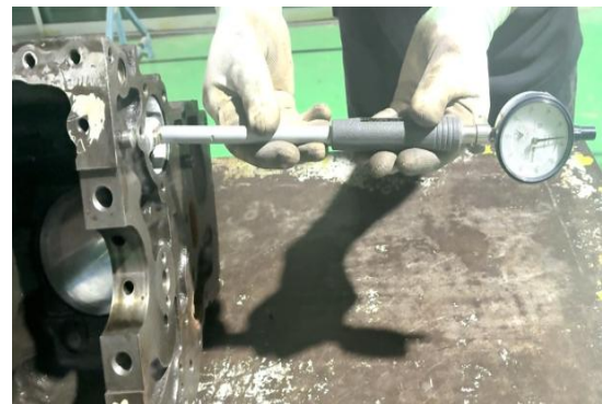
ภาพที่ 1.76 การใช้เกจวัดกระบอกสูบตรวจวัดขนาดความโตกระบอกสูบและบุชเพลาลูกเบี้ยวเครื่องยนต์
