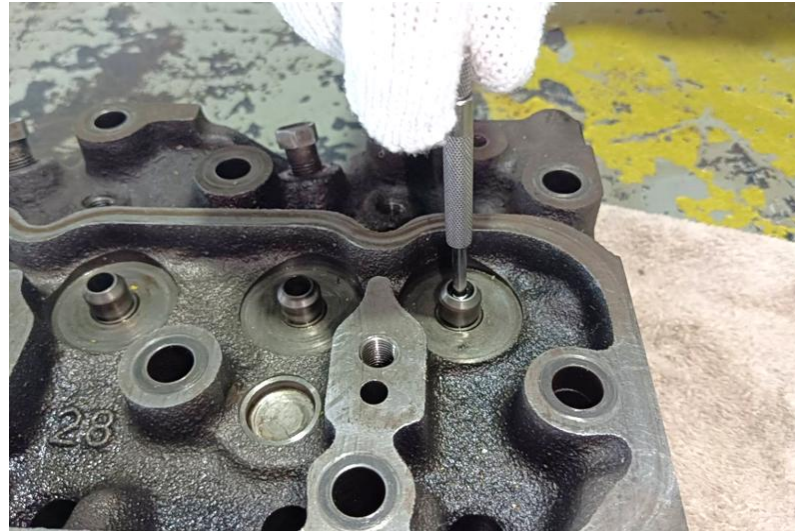
ภาพที่ 1.69 การใช้เกจวัดรูในตรวจวัดขนาดรูของปลอกนำก้านลิ้นเครื่องยนต์ (ที่มา : เดช ทองแก้ว, 2567)
