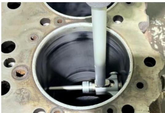
ภาพที่ 1.76 การใช้เกจวัดกระบอกสูบตรวจวัดขนาดความโตกระบอกสูบและบุชเพลาลูกเบี้ยวเครื่องยนต์
