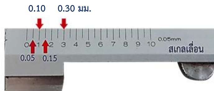
ภาพที่ 1.8 การอ่านค่าบนสเกลเลื่อนของเวอร์เนียคาลิเปอร์แบบธรรมดา (1/20 มิลลิเมตร) (ที่มา : เดช ทองแก้ว, 2567)
