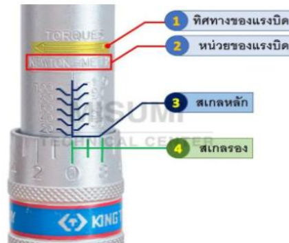
ภาพที่ 1.60 ส่วนประกอบสเกลปรับค่าแรงบิดของประแจวัดแรงบิด (ที่มา : https://misumitechnical.com , สืบค้น 20 พฤษภาคม 2567)
