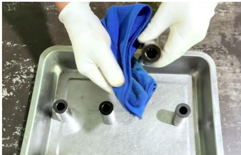
ภาพที่ 4.54 การทำความสะอาดสลักลูกสูบเครื่องยนต์
