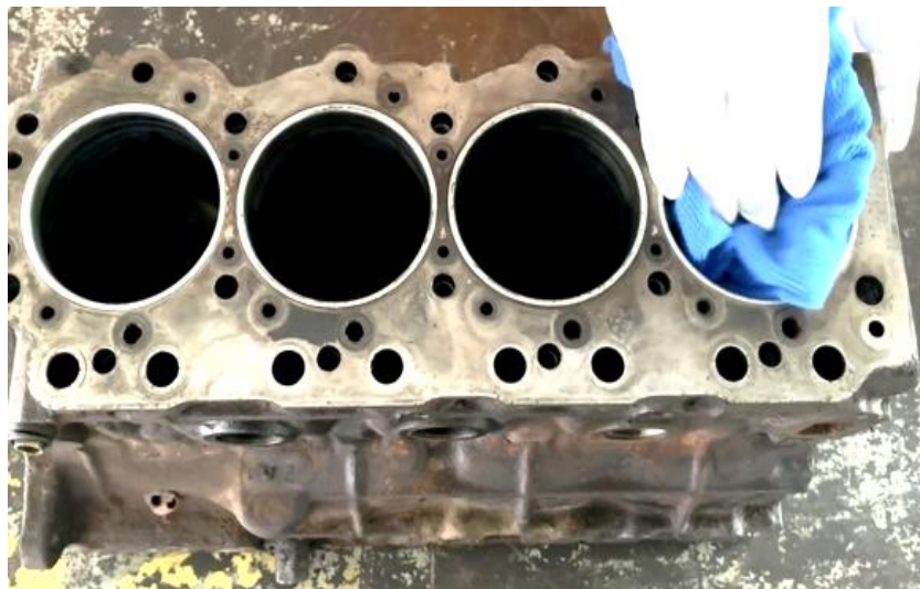
ภาพที่ 4.28 การทำความสะอาดกระบอกสูบเครื่องยนต์ (ที่มา : เดช ทองแก้ว, 2567)
