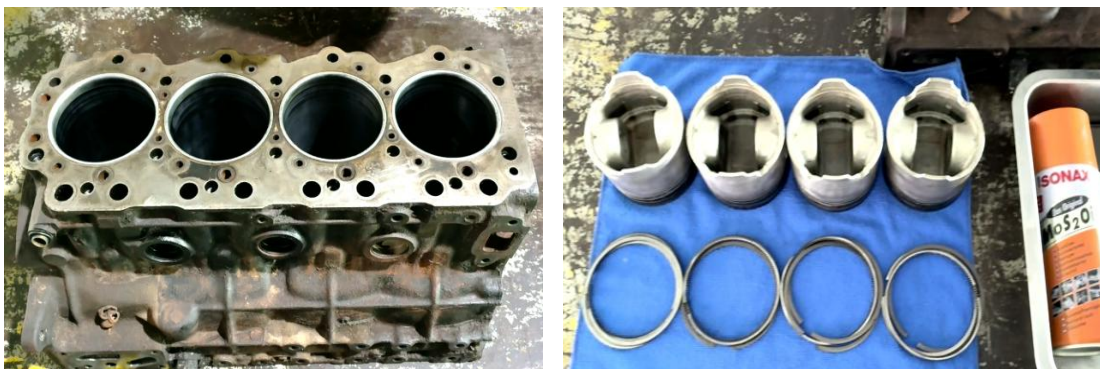
ภาพที่ 4.5 ชิ้นส่วนเครื่องยนต์ในการปฏิบัติงานตรวจวัดระยะห่างปากแหวนลูกสูบและระยะห่างแหวนลูกสูบกับร่องแหวนลูกสูบเครื่องยนต์ (ที่มา : เดช ทองแก้ว, 2567)
