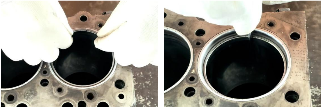
ภาพที่ 4.16 การตรวจวัดระยะห่างปากแหวนลูกสูบแหวนกวาดน้ำมัน จุดการตรวจวัดตำแหน่งที่ 1 (ที่มา : เดช ทองแก้ว, 2567)
