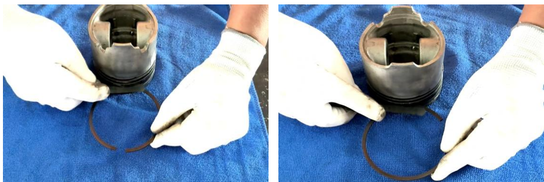
ภาพที่ 4.19 การตรวจวัดระยะห่างแหวนลูกสูบกับร่องแหวนลูกสูบแหวนอัดตัวที่ 1 (ที่มา : เดช ทองแก้ว, 2567)
