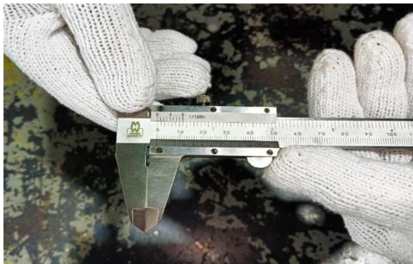
ภาพที่ 4.9 การตรวจสอบความเที่ยงตรงของเวอร์เนียคาลิปเปอร์ (ที่มา : เดช ทองแก้ว, 2567)
