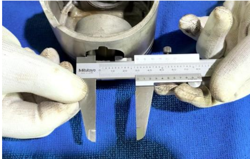
ภาพที่ 4.57 การตรวจวัดความโตเบื้องต้นของรูสลักลูกสูบเครื่องยนต์ (ที่มา : เดช ทองแก้ว, 2567)
