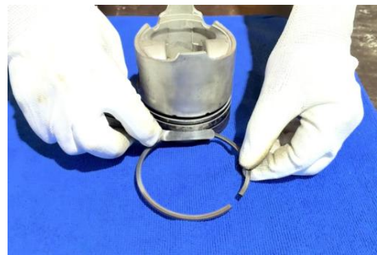
ภาพที่ 4.3 การตรวจวัดระยะห่างแหวนลูกสูบกับร่องแหวนลูกสูบเครื่องยนต์ (ที่มา : เดช ทองแก้ว, 2567)
