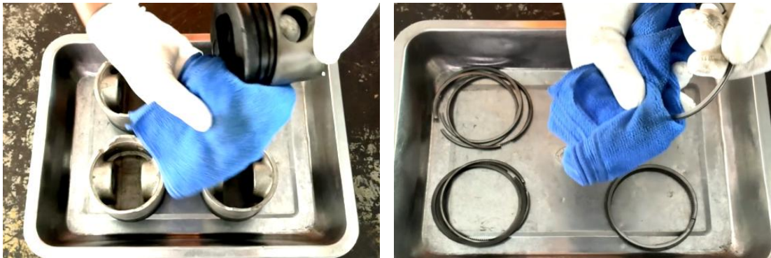
ภาพที่ 4.7 การทำความสะอาดลูกสูบและแหวนลูกสูบเครื่องยนต์ (ที่มา : เดช ทองแก้ว, 2567)
