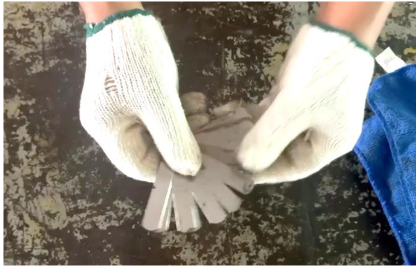
ภาพที่ 4.8 การทำความสะอาดและตรวจสอบความสมบูรณ์ของแผ่นวาล์วฟิลเลอร์เกจ (ที่มา : เดช ทองแก้ว, 2567)
