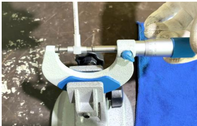
ภาพที่ 4.62 การใช้ไมโครมิเตอร์วัดนอกตรวจวัดความโตรูสลักลูกสูบจากเกจวัดรูขนาดใหญ่ (ที่มา : เดช ทองแก้ว, 2567)
