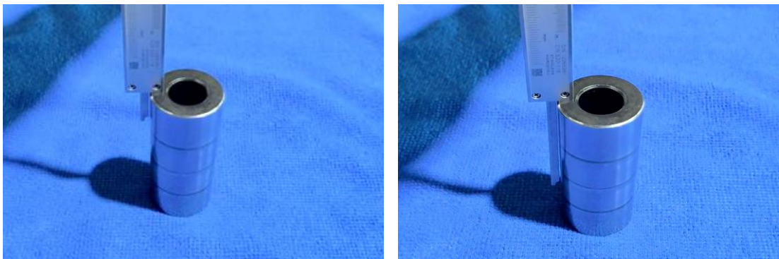
ภาพที่ 4.66 การกำหนดระยะจุดวัดความโตสลักลูกสูบเครื่องยนต์ (ที่มา : เดช ทองแก้ว, 2567)
