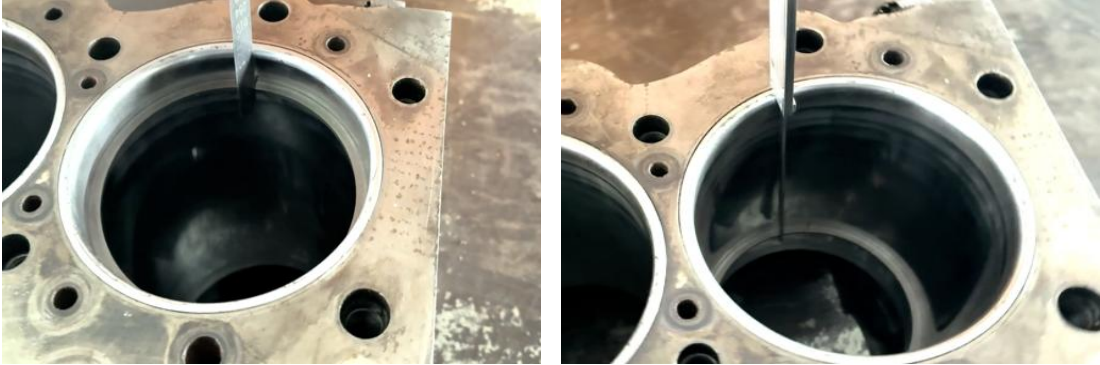
ภาพที่ 4.10 การกำหนดระยะจุดวัดระยะห่างปากแหวนลูกสูบในกระบอกสูบเครื่องยนต์ (ที่มา : เดช ทองแก้ว, 2567)
