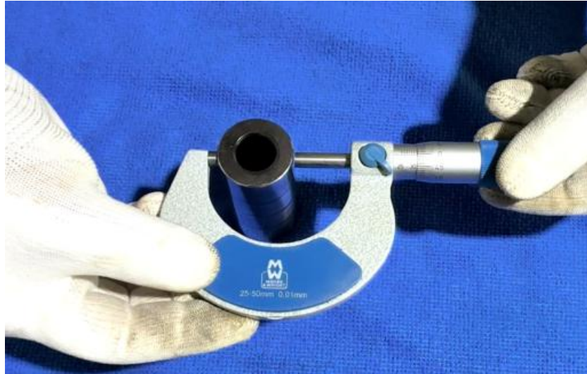
ภาพที่ 4.67 การตรวจวัดความโตสลักลูกสูบเครื่องยนต์สูบที่ 1 จุดการตรวจวัดตำแหน่งที่ 1 แนวที่ 1 (ที่มา : เดช ทองแก้ว, 2567)
