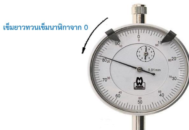
ภาพที่ 4.40 การอ่านค่าความโตภายในกระบอกสูบเครื่องยนต์จากหน้าปัดเกจวัดกระบอกสูบ (ที่มา : เดช ทองแก้ว, 2567)
