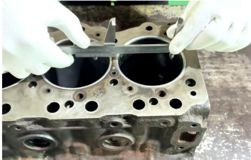
ภาพที่ 4.31 การตรวจวัดขนาดความโตเบื้องต้นของกระบอกสูบเครื่องยนต์ (ที่มา : เดช ทองแก้ว, 2567)
