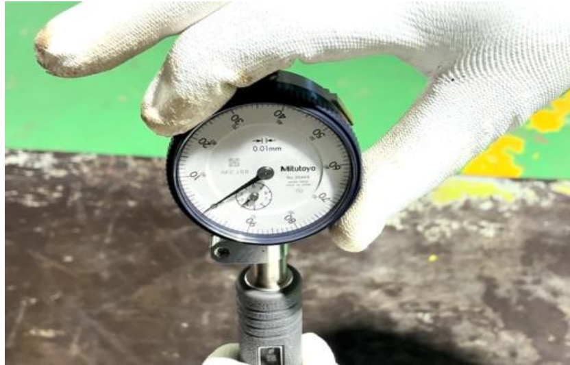
ภาพที่ 4.37 การปรับเกจหน้าปิดเกจวัดกระบอกสูบให้เข็มยาวตรงกับสเกล “0” เพื่อให้ขนาด เกจวัดกระบอกสูบมีค่าเท่ากับไมโครมิเตอร์วัดนอก (ที่มา : เดช ทองแก้ว, 2567)
