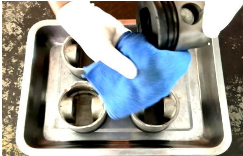
ภาพที่ 4.29 การทำความสะอาดลูกสูบเครื่องยนต์ (ที่มา : เดช ทองแก้ว, 2567)
