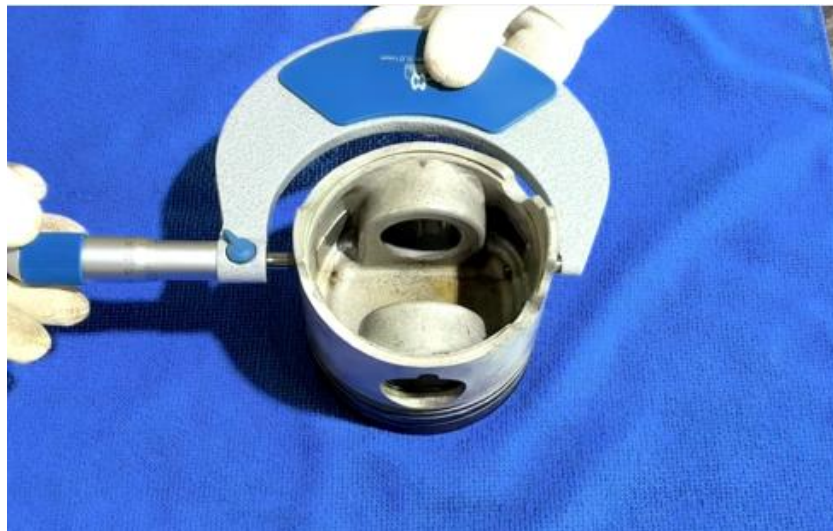
ภาพที่ 4.46 การตรวจวัดความโตลูกสูบเครื่องยนต์สูบที่ 1 (ที่มา : เดช ทองแก้ว, 2567)
