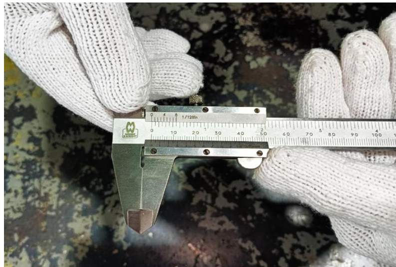
ภาพที่ 4.30 การตรวจสอบความเที่ยงตรงของเวอร์เนียคาลิปเปอร์ (ที่มา : เดช ทองแก้ว, 2567)
