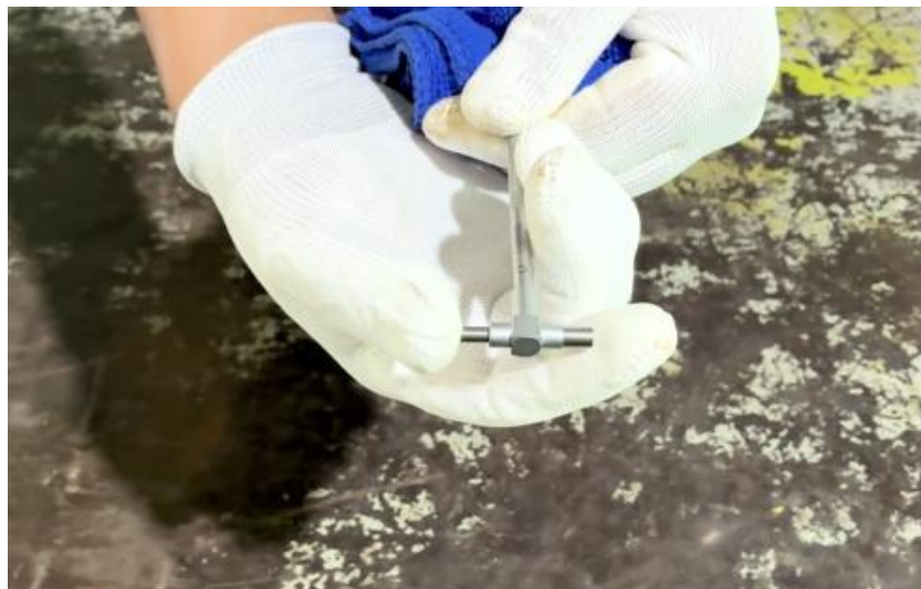
ภาพที่ 4.58 การตรวจสอบสภาพความสมบูรณ์ของเกจวัดรูขนาดใหญ่ (ที่มา : เดช ทองแก้ว, 2567)
