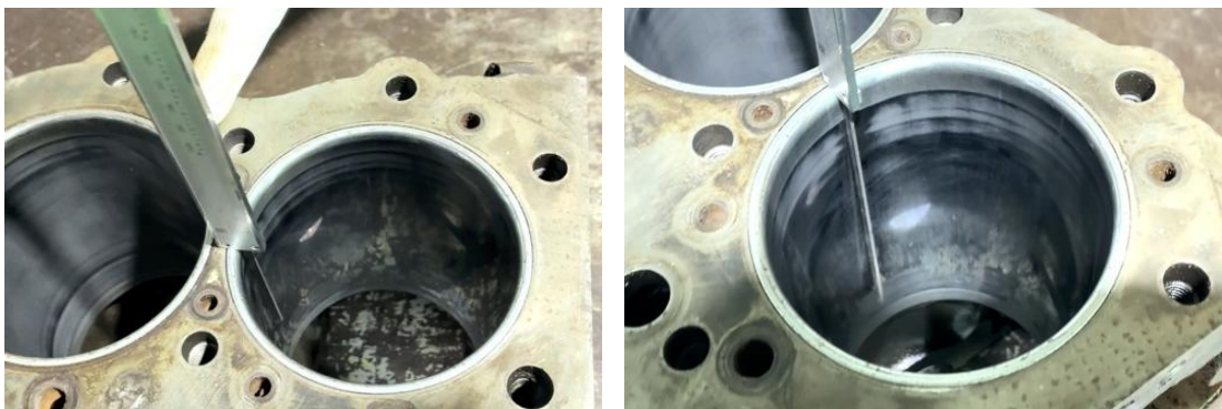
ภาพที่ 4.38 การกำหนดระยะจุดวัดความโตภายในกระบอกสูบเครื่องยนต์ (ที่มา : เดช ทองแก้ว, 2567)
