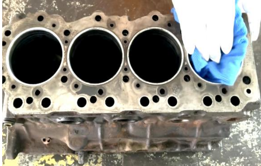
ภาพที่ 4.6 การทำความสะอาดกระบอกสูบเครื่องยนต์ (ที่มา : เดช ทองแก้ว, 2567)
