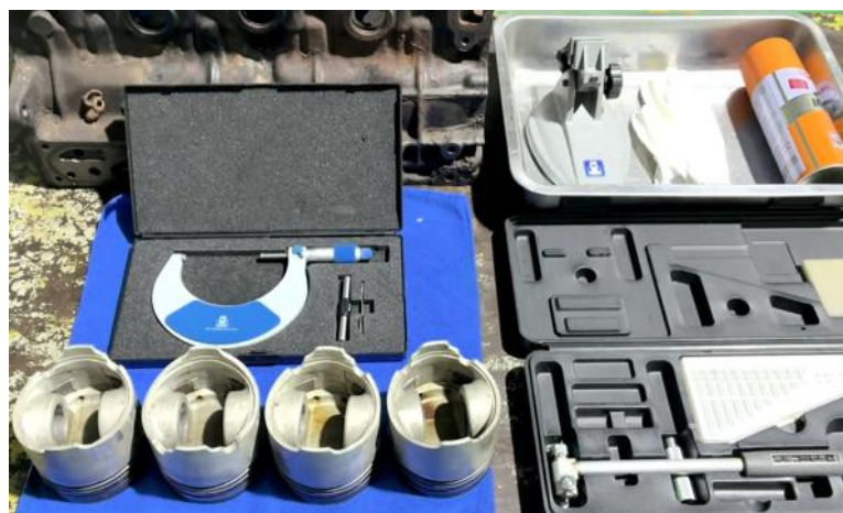
ภาพที่ 4.26 เครื่องมือวัดละเอียด วัสดุ และอุปกรณ์ในการปฏิบัติงานตรวจวัดระยะห่างลูกสูบกับผนังกระบอกสูบเครื่องยนต์ (ที่มา : เดช ทองแก้ว, 2567)
