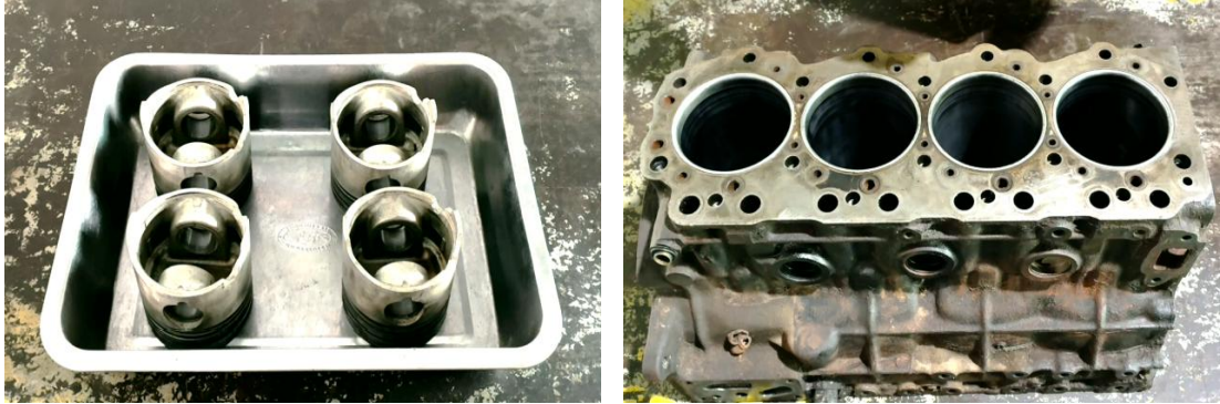
ภาพที่ 4.27 ชิ้นส่วนเครื่องยนต์ในการปฏิบัติงานตรวจวัดระยะห่างลูกสูบ กับผนังกระบอกสูบเครื่องยนต์ (ที่มา : เดช ทองแก้ว, 2567)
