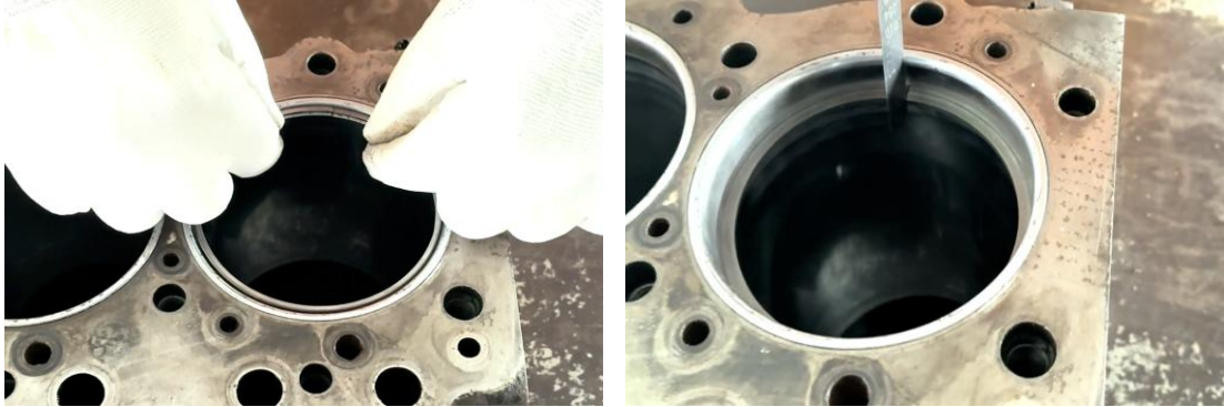
ภาพที่ 4.14 การตรวจวัดระยะห่างปากแหวนลูกสูบแหวนอัดตัวที่ 2 จุดการตรวจวัดตำแหน่งที่ 1 (ที่มา : เดช ทองแก้ว, 2567)
