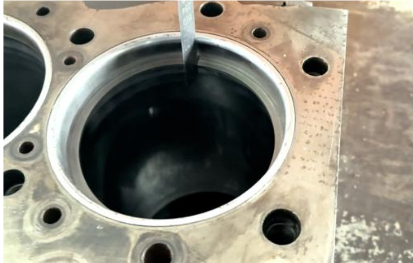
ภาพที่ 4.12 การตรวจวัดระยะห่างปากแหวนลูกสูบแหวนอัดตัวที่ 1 จุดการตรวจวัดตำแหน่งที่ 1 (ที่มา : เดช ทองแก้ว, 2567)
