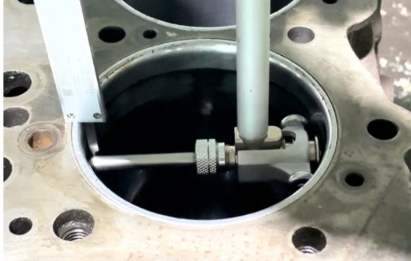
ภาพที่ 4.41 การตรวจวัดความโตภายในกระบอกลูกสูบเครื่องยนต์สูบที่ 1 ตำแหน่งที่ 1 แนวที่ 2 (ที่มา : เดช ทองแก้ว, 2567)
