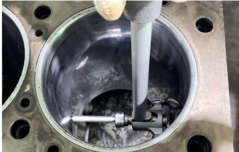
ภาพที่ 4.43 การตรวจวัดความโตภายในกระบอกสูบเครื่องยนต์สูบที่ 1 ตำแหน่งที่ 3 (ที่มา : เดช ทองแก้ว, 2567)
