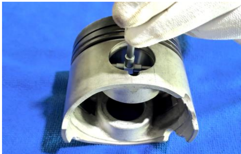
ภาพที่ 4.64 การตรวจวัดความโตรูด้านหลังของสลักลูกสูบเครื่องยนต์สูบที่ 1 (ที่มา : เดช ทองแก้ว, 2567)
