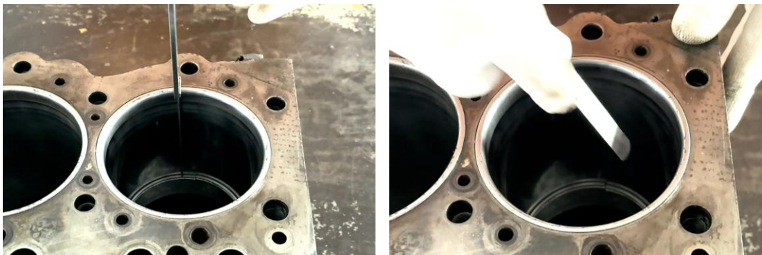
ภาพที่ 4.17 การตรวจวัดระยะห่างปากแหวนลูกสูบแหวนกวาดน้ำมัน จุดการตรวจวัดตำแหน่งที่ 2 (ที่มา : เดช ทองแก้ว, 2567)
