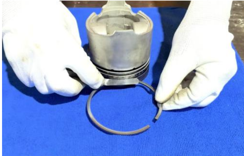
ภาพที่ 4.20 การตรวจวัดระยะห่างแหวนลูกสูบกับร่องแหวนลูกสูบแหวนอัดตัวที่ 2 (ที่มา : เดช ทองแก้ว, 2567)
