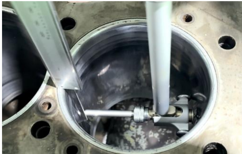
ภาพที่ 4.42 การตรวจวัดความโตภายในกระบอกลูกสูบเครื่องยนต์สูบที่ 1 ตำแหน่งที่ 2 แนวที่ 1 (ที่มา : เดช ทองแก้ว, 2567)
