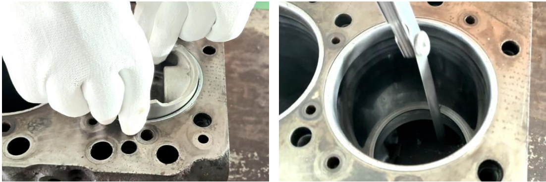
ภาพที่ 4.15 การตรวจวัดระยะห่างปากแหวนลูกสูบแหวนอัดตัวที่ 2 จุดการตรวจวัดตำแหน่งที่ 2 (ที่มา : เดช ทองแก้ว, 2567)
