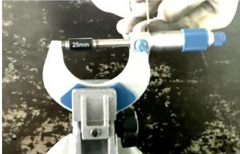
ภาพที่ 4.59 การตรวจสอบความเที่ยงตรงของไมโครมิเตอร์วัดนอก (ที่มา : เดช ทองแก้ว, 2567)
