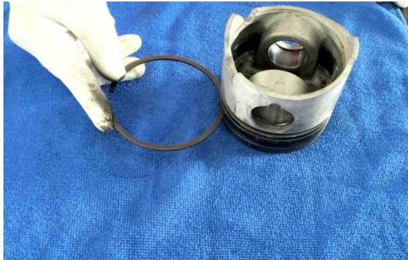
ภาพที่ 4.18 การใส่แหวนลูกสูบแหวนอัดตัวที่ 1 เข้าไปในร่องแหวนลูกสูบร่องแหวนอัดร่องที่ 1 (ที่มา : เดช ทองแก้ว, 2567)
