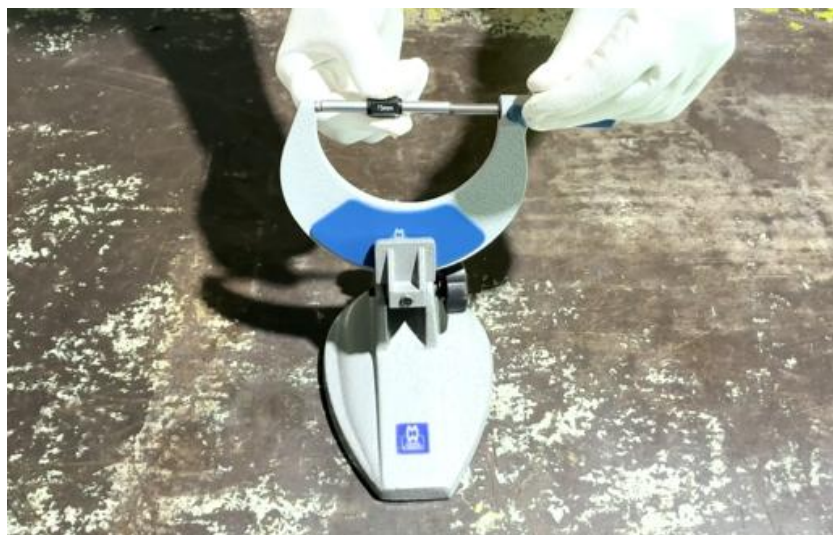
ภาพที่ 4.32 การตรวจสอบความเที่ยงตรงของไมโครมิเตอร์วัดนอก (ที่มา : เดช ทองแก้ว, 2567)
