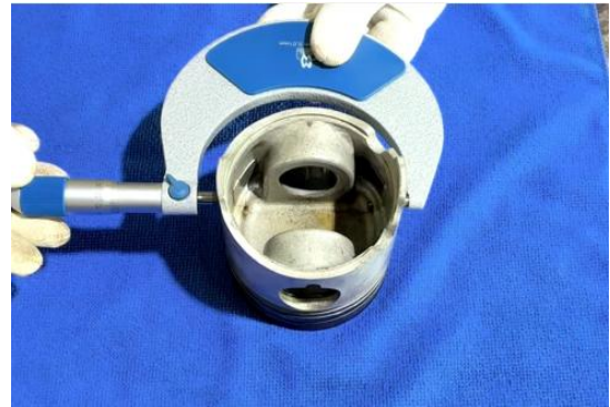
ภาพที่ 4.23 การตรวจวัดความโตลูกสูบเครื่องยนต์ (ที่มา : เดช ทองแก้ว, 2567)
