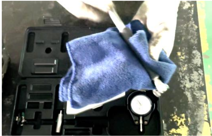
ภาพที่ 4.33 การตรวจสอบสภาพความพร้อมของเกจวัดกระบอกสูบ (ที่มา : เดช ทองแก้ว, 2567)
