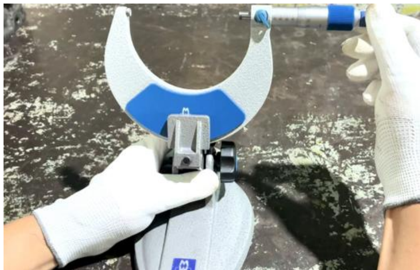
ภาพที่ 4.34 การปรับตั้งค่าไมโครมิเตอร์ให้ได้ระยะวัดเท่ากับหรือใกล้เคียงค่าความโตกระบอกสูบ เครื่องยนต์ (ที่มา : เดช ทองแก้ว, 2567)
