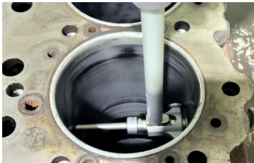
ภาพที่ 4.44 การตรวจวัดความโตภายในกระบอกสูบเครื่องยนต์สูบที่ 2, 3 และ 4 (ที่มา : เดช ทองแก้ว, 2567)
