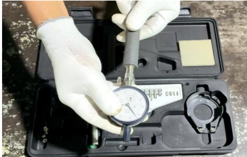
ภาพที่ 4.35 การประกอบเกจวัดกระบอบกสูบเพื่อตรวจวัดความโตกระบอบกสูบเครื่องยนต์ (ที่มา : เดช ทองแก้ว, 2567)
