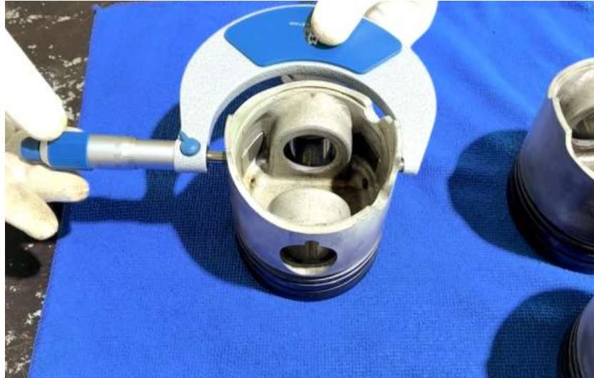
ภาพที่ 4.47 การตรวจวัดความโตลูกสูบเครื่องยนต์สูบที่ 2, 3 และ 4 (ที่มา : เดช ทองแก้ว, 2567)
