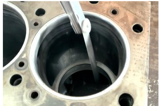
ภาพที่ 4.2 การตรวจวัดระยะห่างปากแหวนลูกสูบเครื่องยนต์ (ที่มา : เดช ทองแก้ว, 2567)
