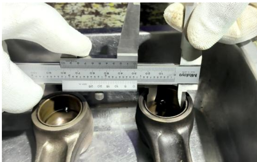
ภาพที่ 5.106 การตรวจวัดความโตเบื้องต้นของบูชก้านสูบเครื่องยนต์ (ที่มา : เดช ทองแก้ว, 2567)
