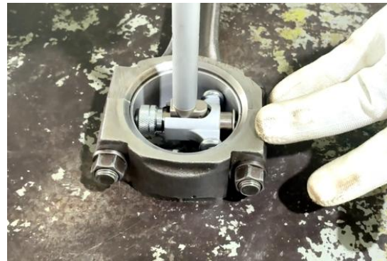
ภาพที่ 5.32 การตรวจวัดความโตภายในลูกปืนข้อก้านสูบเพลาคือเหวี่ยงเครื่องยนต์ (ที่มา : เดช ทองแก้ว, 2567)
