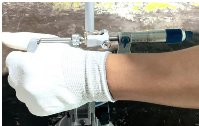
ภาพที่ 5.17 การติดตั้งเกจวัดกระบอกสูบในไมโครมิเตอร์วัดนอกเพื่อปรับตั้งค่าให้เท่ากัน (ที่มา : เดช ทองแก้ว, 2567)
