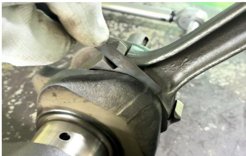
ภาพที่ 5.74 การตรวจวัดระยะห่างด้านข้างก้านสูบกับข้างแก้มข้อก้านสูบเพลาคือเหวี่ยงเครื่องยนต์สูบที่ 1 ด้านขวาของก้านสูบ (ที่มา : เดช ทองแก้ว, 2567)
