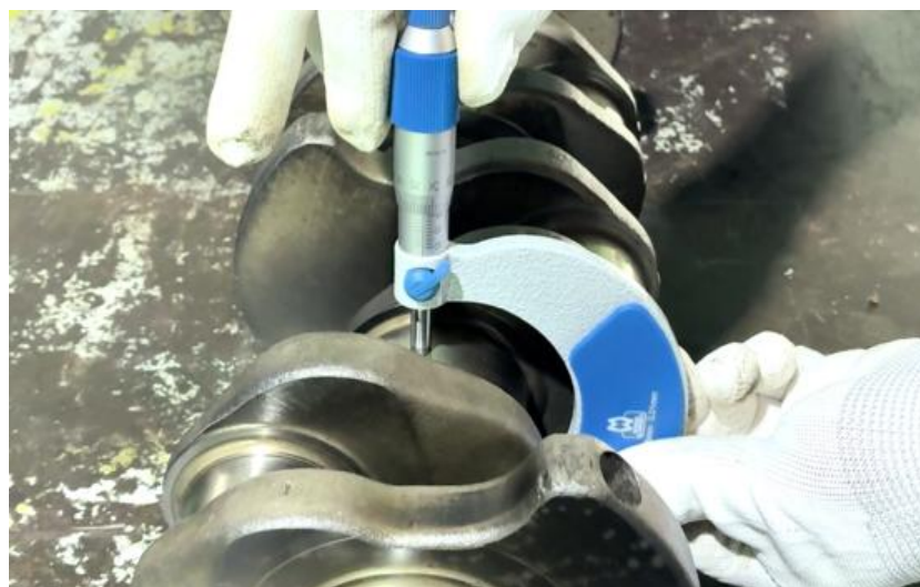
ภาพที่ 5.29 การตรวจวัดความโตข้อหลักเพลาค้อเหวี่ยงข้อที่ 2, 3, 4 และ 5 (ที่มา : เดช ทองแก้ว, 2567)
