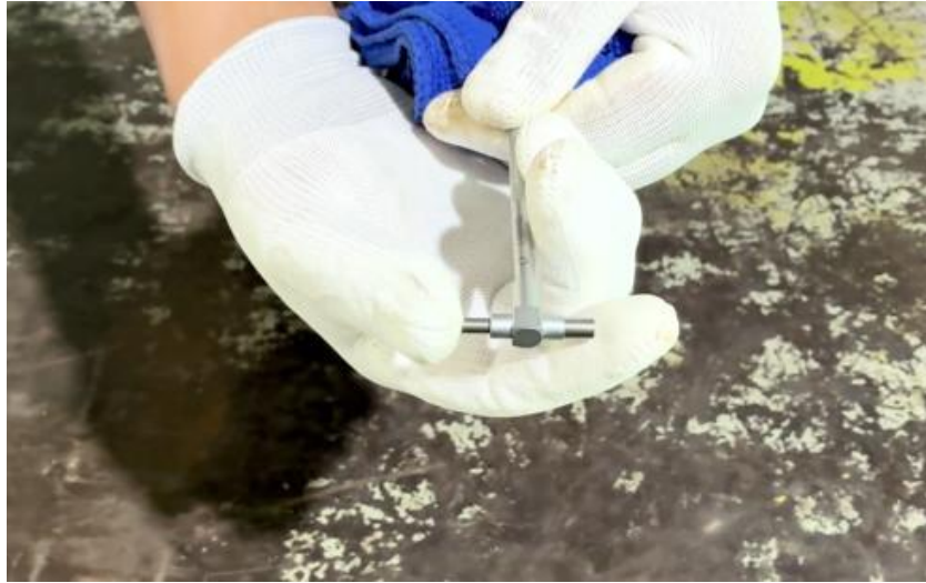
ภาพที่ 5.107 การทำความสะอาดและตรวจสอบสภาพความสมบูรณ์ของเกจวัดรูขนาดใหญ่ (ที่มา : เดช ทองแก้ว, 2567)
