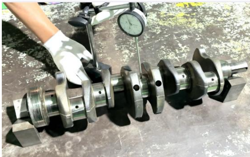
ภาพที่ 5.68 การติดตั้งนาฬิกาวัดเพื่อตรวจวัดการคดของเพลาข้อเหวี่ยงเครื่องยนต์ (ที่มา : เดช ทองแก้ว, 2567)
