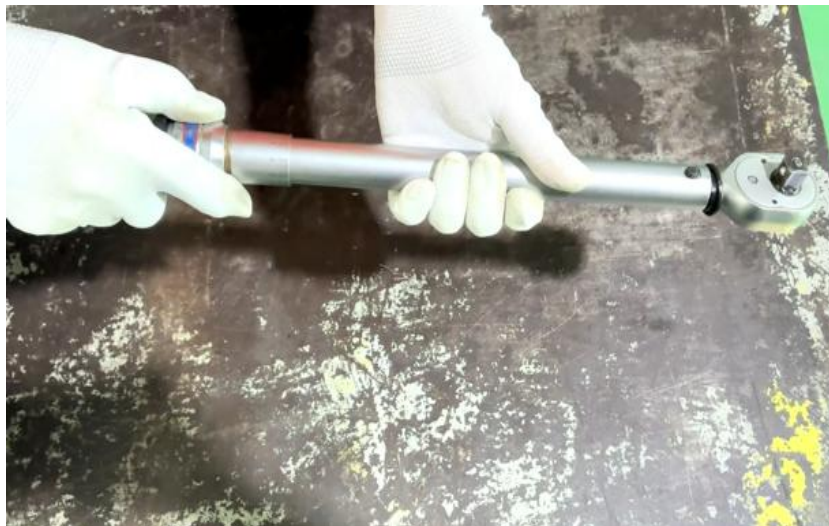
ภาพที่ 5.36 การทำความสะอาดและตรวจสอบความสมบูรณ์ของประแจวัดแรงบิด (ที่มา : เดช ทองแก้ว, 2567)
