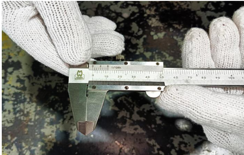
ภาพที่ 5.39 การทำความสะอาดและตรวจสอบความเที่ยงตรงของเวอร์เนียคาลิเปอร์ (ที่มา : เดช ทองแก้ว, 2567)
