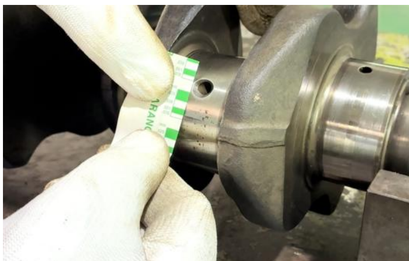
ภาพที่ 5.80 การตรวจวัดระยะช่องว่างน้ำมันข้อก้านสูบกับลูกปืนข้อก้านสูบเพลาค้อเหวี่ยงเครื่องยนต์ (ที่มา : เดช ทองแก้ว, 2567)
