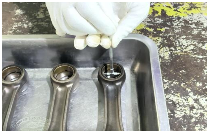
ภาพที่ 5.110 ขั้นตอนการใช้เกจวัดรูขนาดใหญ่ตรวจวัดความโตของบูชก้านสูบเครื่องยนต์ (ที่มา : เดช ทองแก้ว, 2567)
