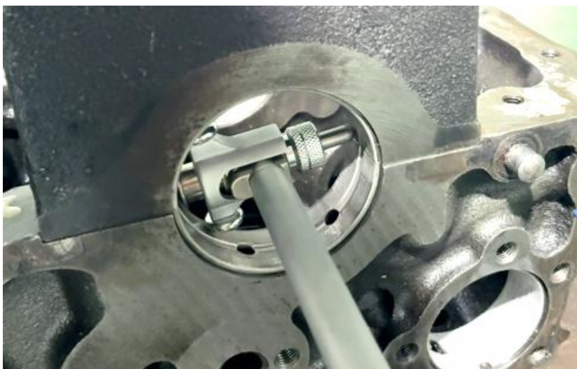
ภาพที่ 5.23 การตรวจวัดความโตภายในลูกปืนข้อหลักเพลาคอเหวี่ยงข้อที่ 1 ของเสื้อสูบเครื่องยนต์ แนวที่ 2 จุดตรวจวัดตำแหน่งที่ 2 (ที่มา : เดช ทองแก้ว, 2567)
