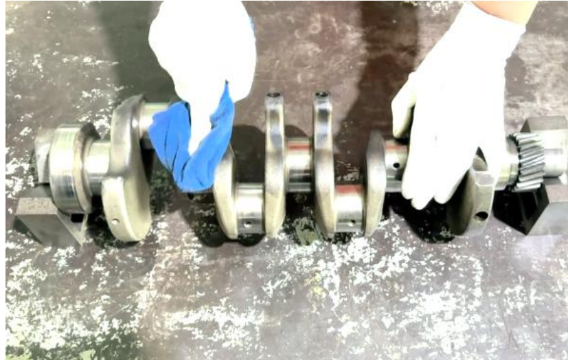
ภาพที่ 5.10 การทำความสะอาดเพลาคือเหียงเครื่องยนต์และวางลงในแท่นรองรับแบบปากตัววี (ที่มา : เดช ทองแก้ว, 2567)
