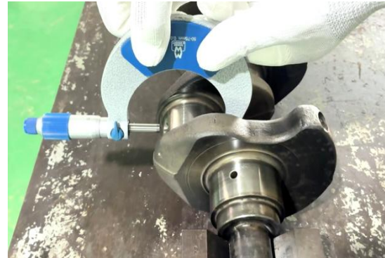
ภาพที่ 5.31 การตรวจวัดความโตข้อก้านสูบเพลาคือเหวี่ยงเครื่องยนต์ (ที่มา : เดช ทองแก้ว, 2567)
