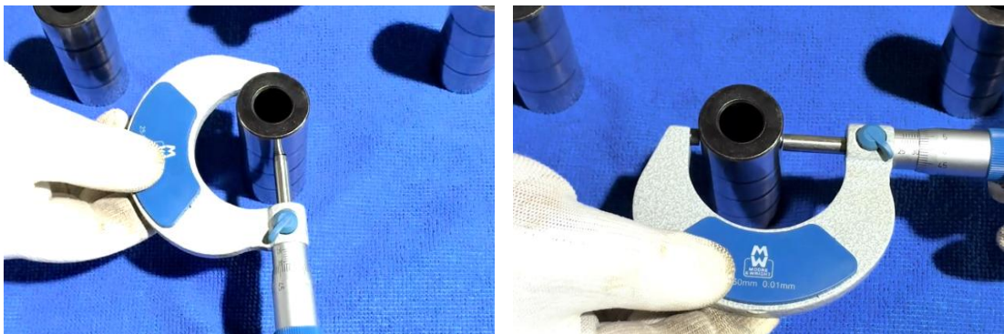
ภาพที่ 5.118 การตรวจวัดความโตสลักลูกสูบเครื่องยนต์สูบที่ 2, 3 และ 4 (ที่มา : เดช ทองแก้ว, 2567)
