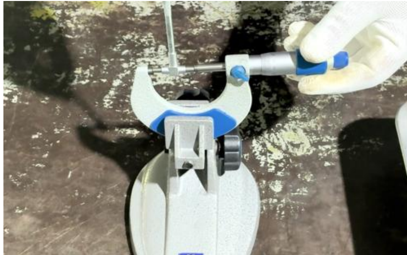
ภาพที่ 5.111 การใช้ไมโครมิเตอร์วัดนอกตรวจวัดความโตบูชก้านสูบเครื่องยนต์จากเกจวัดรูขนาดใหญ่ (ที่มา : เดช ทองแก้ว, 2567)
