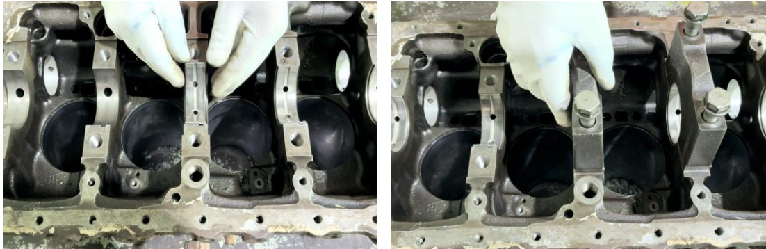
ภาพที่ 5.8 การประกอบลูกปืนพร้อมฝาประกับข้อหลักเพลาคอเหวี่ยงเข้ากับเสื้อสูบเครื่องยนต์ (ที่มา : เดช ทองแก้ว, 2567)
