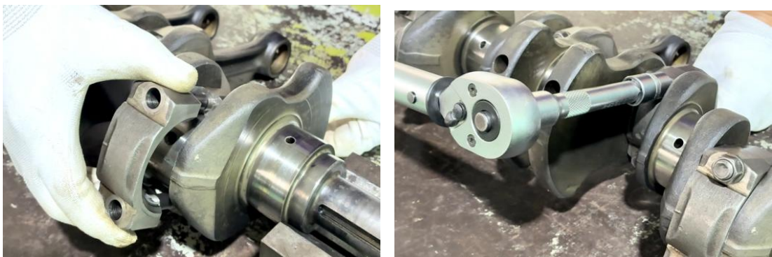
ภาพที่ 5.94 การประกอบฝาประกับข้อก้านสูบเข้ากับเพลาคอเหวี่ยง และขันโบลท์ยึดฝาประกับข้อก้านสูบเครื่องยนต์ (ที่มา : เดช ทองแก้ว, 2567)
