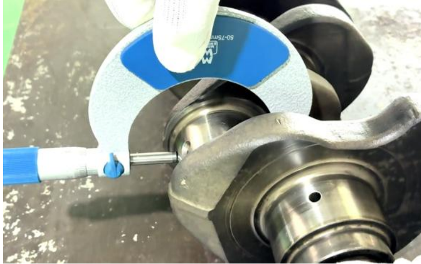
ภาพที่ 5.55 การตรวจวัดความโตของก้านสูบเพลาคือเหียงสูบที่ 1 แนวที่ 1 จุดการตรวจวัดตำแหน่งที่ 2 (ที่มา : เดช ทองแก้ว, 2567)
