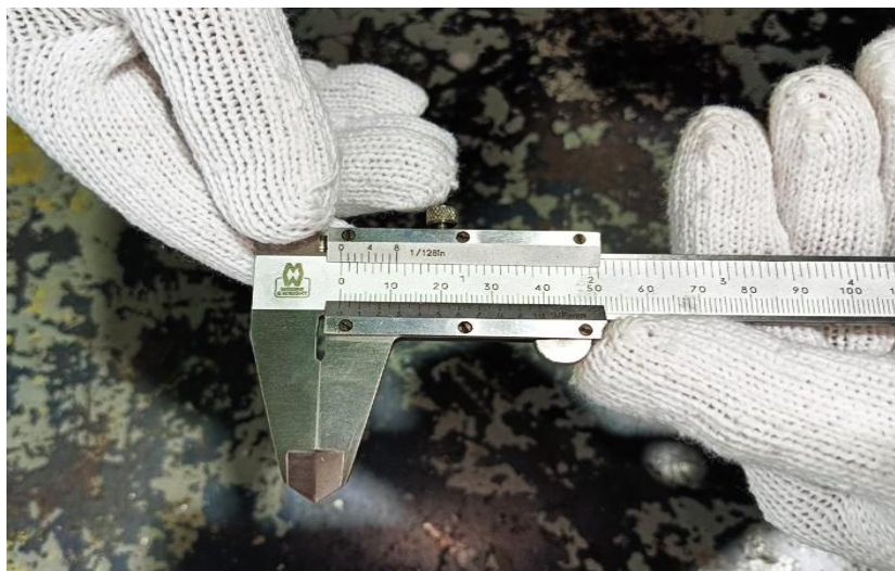
ภาพที่ 5.11 การทำความสะอาดและตรวจสอบความเที่ยงตรงของเวอร์เนียคาลิเปอร์ (ที่มา : เดช ทองแก้ว, 2567)
