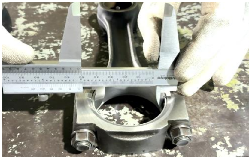
ภาพที่ 5.40 การตรวจวัดความโตภายในเบื้องต้นของลูกปืนข้อก้านสูบเพลาค้อเหวี่ยง (ที่มา : เดช ทองแก้ว, 2567)
