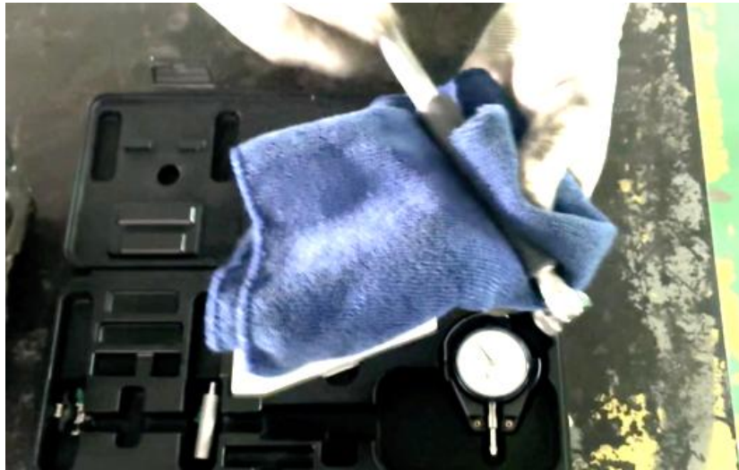
ภาพที่ 5.14 การทำความสะอาดและตรวจสอบสภาพความสมบูรณ์ของเกว้วัดกระบอกสูบ (ที่มา : เดช ทองแก้ว, 2567)
