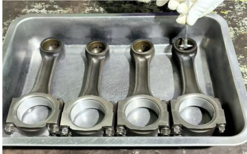
ภาพที่ 5.109 การตรวจวัดความโตของบูชก้านสูบเครื่องยนต์ด้วยเกจวัดรูขนาดใหญ่ (ที่มา : เดช ทองแก้ว, 2567)
