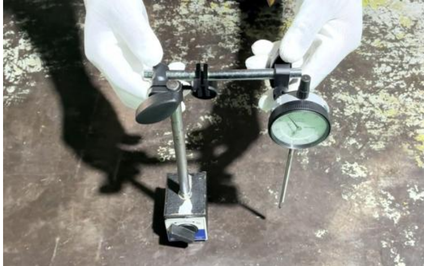
ภาพที่ 5.67 การติดตั้งนาฬิกาวัดเข้ากับชุดแขนยึดในแท่นยึดนาฬิกาวัด (ที่มา : เดช ทองแก้ว, 2567)
