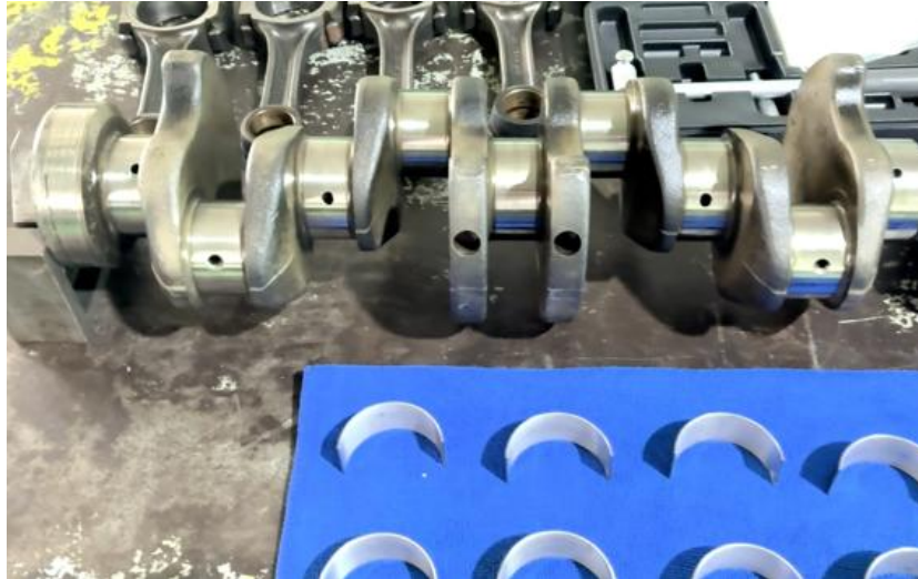
ภาพที่ 5.35 เครื่องมือวัดละเอียด วัสดุ และอุปกรณ์ในการปฏิบัติงานตรวจวัดระยะห่างข้อก้านสูบกับลูกปืนข้อก้านสูบเพลาคอเหวี่ยงเครื่องยนต์ (ที่มา : เดช ทองแก้ว, 2567)
