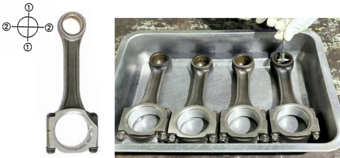
ภาพที่ 5.99 จุดการตรวจวัดความโตบุชก้านสูบเครื่องยนต์ (ที่มา : เดช ทองแก้ว, 2567)
