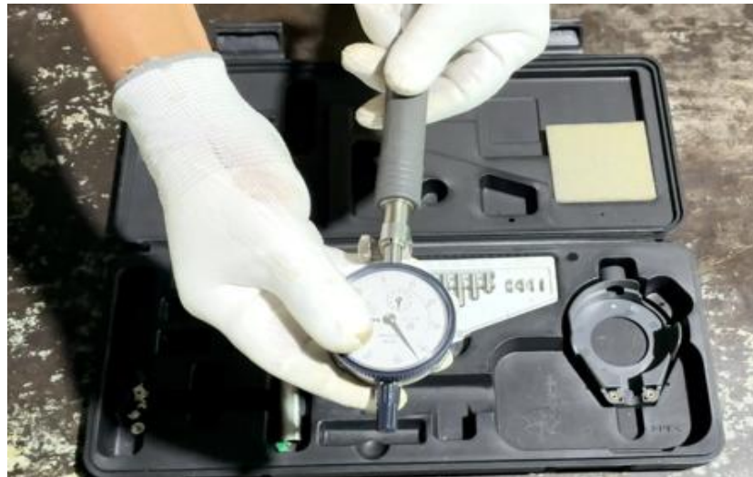
ภาพที่ 5.16 การประกอบเกจวัดกระบอกสูบเพื่อตรวจวัดความโตลูกปืนข้อหลักเพลาค้อเหวี่ยง (ที่มา : เดช ทองแก้ว, 2567)
