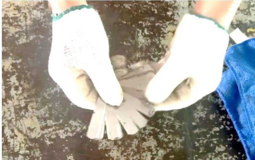
ภาพที่ 5.65 การทำความสะอาดและตรวจสอบความสมบูรณ์ของแผ่นวัดฟิลเลอร์เกจ (ที่มา : เดช ทองแก้ว, 2567)
