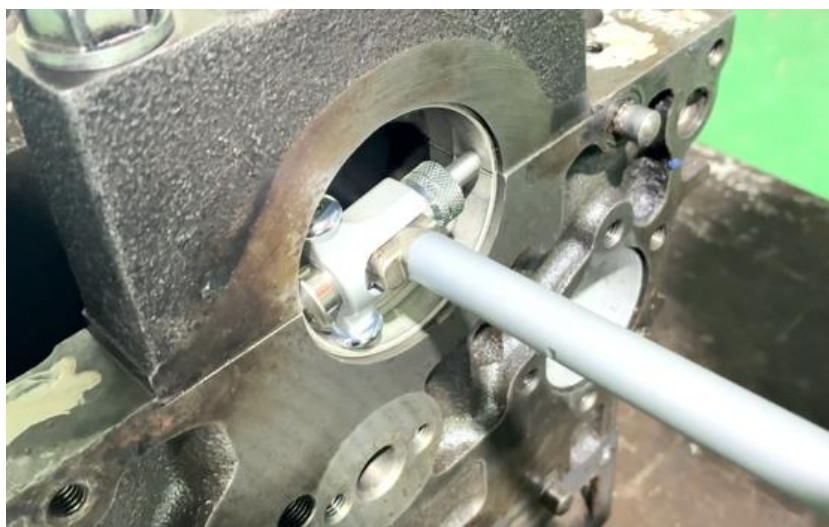
ภาพที่ 5.21 การตรวจวัดความโตภายในลูกปืนข้อหลักเพลาคอเหวี่ยงข้อที่ 1 ของเสื้อสูบเครื่องยนต์ แนวที่ 2 จุดการตรวจวัดตำแหน่งที่ 1 (ที่มา : เดช ทองแก้ว, 2567)
