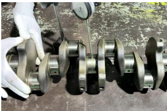
ภาพที่ 5.58 การคดของเพลาค้อนเหวี่ยงและระยะห่างด้านข้างก้านสูบเครื่องยนต์ (ที่มา : เดช ทองแก้ว, 2567)
