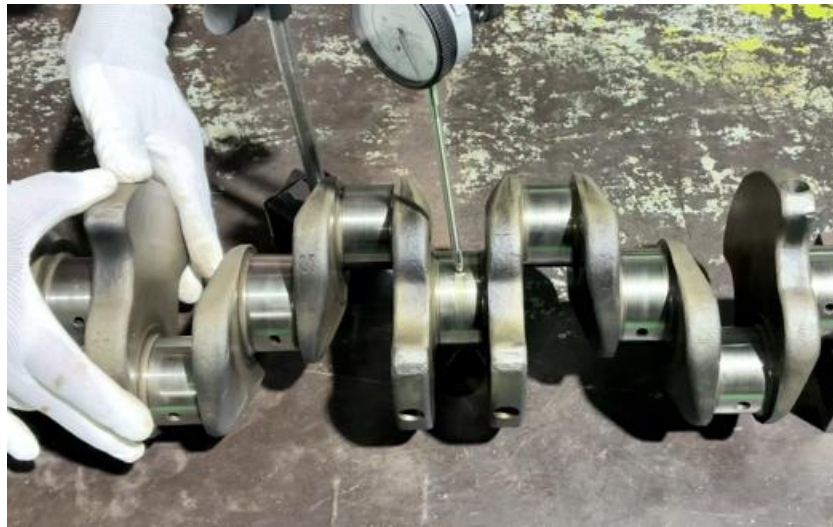
ภาพที่ 5.59 การตรวจวัดการคดของเพลาค้อเหวี่ยงเครื่องยนต์ (ที่มา : เดช ทองแก้ว, 2567)
