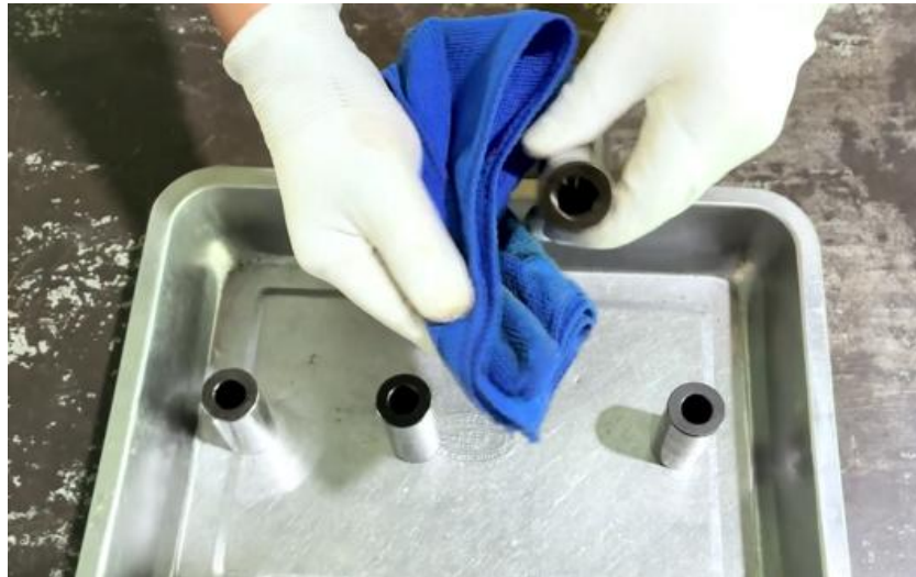
ภาพที่ 5.103 การทำความสะอาดสลักลูกสูบเครื่องยนต์ (ที่มา : เดช ทองแก้ว, 2567)
