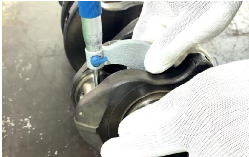
ภาพที่ 5.54 การตรวจวัดความโตของก้านสูบเพลาคือเหวี่ยงสูบที่ 1 แนวที่ 2 จุดการตรวจวัดตำแหน่งที่ 1 (ที่มา : เดช ทองแก้ว, 2567)
