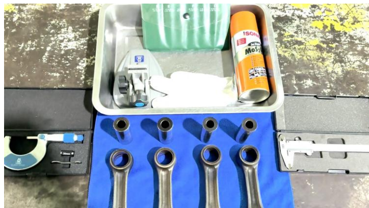
ภาพที่ 5.101 เครื่องมือวัดละเอียด วัสดุ และอุปกรณ์ในการปฏิบัติงานตรวจวัดระยะห่างสลักลูกสูบกับบูชก้านสูบเครื่องยนต์ (ที่มา : เดช ทองแก้ว, 2567)
