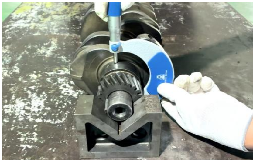
ภาพที่ 5.27 การตรวจวัดความโตข้อหลักเพลาข้อเหวี่ยงข้อที่ 1 ในแนวที่ 1 จุดการตรวจวัดตำแหน่งที่ 2 (ที่มา : เดช ทองแก้ว, 2567)
