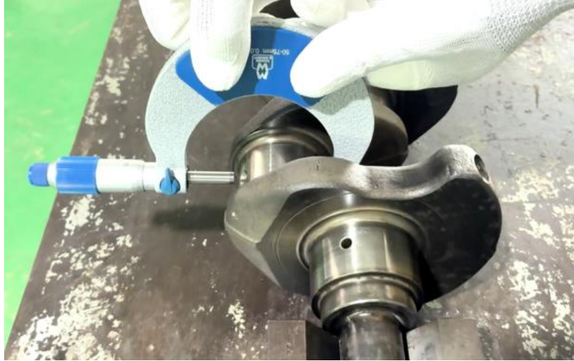
ภาพที่ 5.53 การตรวจวัดความโตของก้านสูบเพลาคือเหวี่ยงสูบที่ 1 แนวที่ 1 จุดการตรวจวัดตำแหน่งที่ 1 (ที่มา : เดช ทองแก้ว, 2567)
