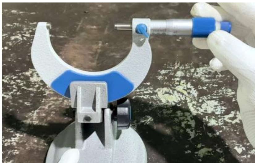
ภาพที่ 5.15 การปรับตั้งค่าไมโครมิเตอร์ให้ได้ระยะวัดเท่ากับหรือใกล้เคียงค่าความโตภายใน ลูกปืนข้อหลักเพลาค้อเหวี่ยง (ที่มา : เดช ทองแก้ว, 2567)
