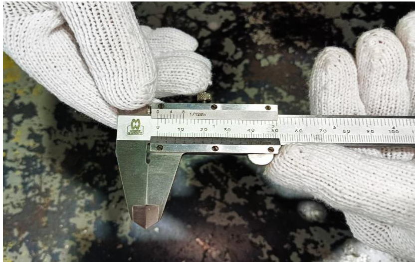
ภาพที่ 5.105 การทำความสะอาดและตรวจสอบความเที่ยงตรงของเวอร์เนียคาลิปเปอร์ (ที่มา : เดช ทองแก้ว, 2567)
