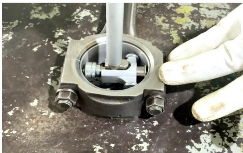
ภาพที่ 5.52 การตรวจวัดความโตภายในลูกปืนข้อก้านสูบเพลาคอเหวี่ยงสูบที่ 4 ของเครื่องยนต์ (ที่มา : เดช ทองแก้ว, 2567)
