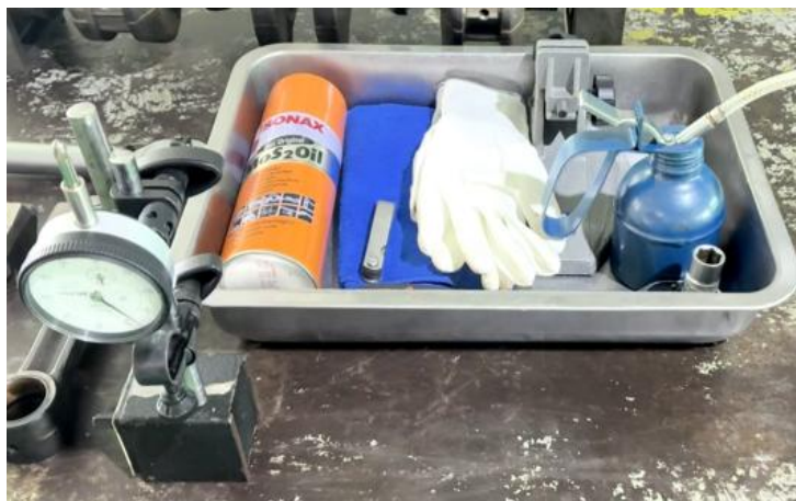
ภาพที่ 5.61 เครื่องมือวัดละเอียด วัสดุ และอุปกรณ์ในการปฏิบัติงานตรวจวัดการคดของเพลาค้อเหวี่ยง และระยะห่างด้านข้างก้านสูบเครื่องยนต์ (ที่มา : เดช ทองแก้ว, 2567)
