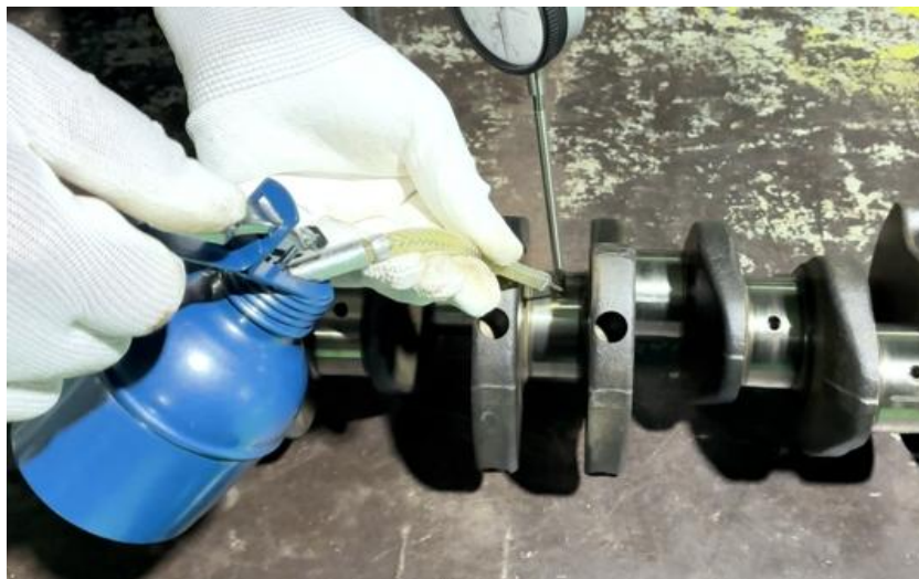
ภาพที่ 5.70 การหล่อลื่นจุดสัมผัสจุดตรวจวัดการคดของเพลาข้อเหวี่ยงเครื่องยนต์ (ที่มา : เดช ทองแก้ว, 2567)
