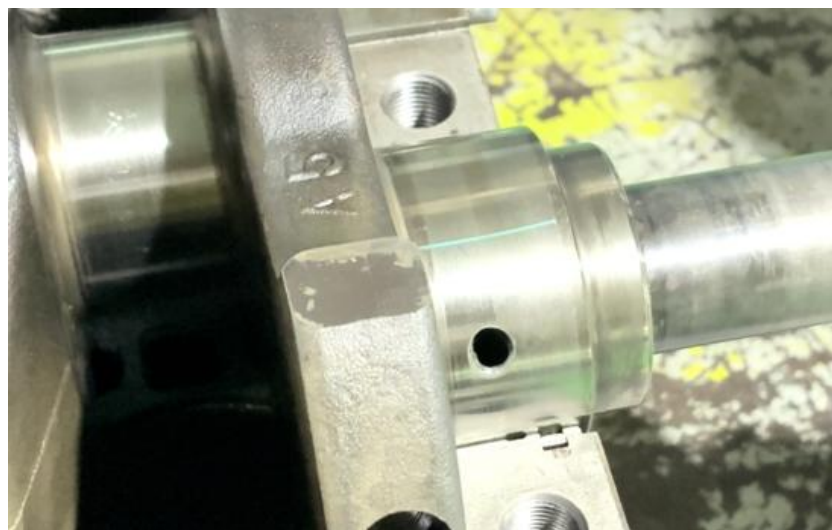
ภาพที่ 5.86 การวางพลาสติกเกจลงบนข้อหลักเพลาค้อเหวี่ยงเครื่องยนต์ (ที่มา : เดช ทองแก้ว, 2567)
