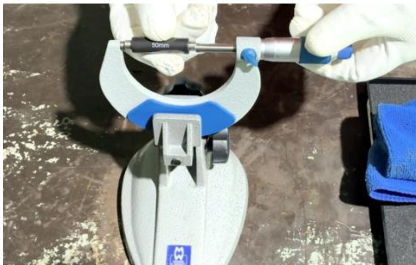
ภาพที่ 5.13 การทำความสะอาดและตรวจสอบความเที่ยงตรงของไมโครมิเตอร์วัดนอก (ที่มา : เดช ทองแก้ว, 2567)
