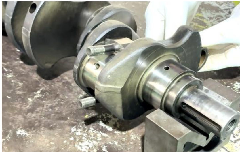
ภาพที่ 5.92 การประกอบก้านสูบเข้าไปในเพลาคอเหวี่ยงในแนวตะแคงข้างตรงข้ามกัน (ที่มา : เดช ทองแก้ว, 2567)
