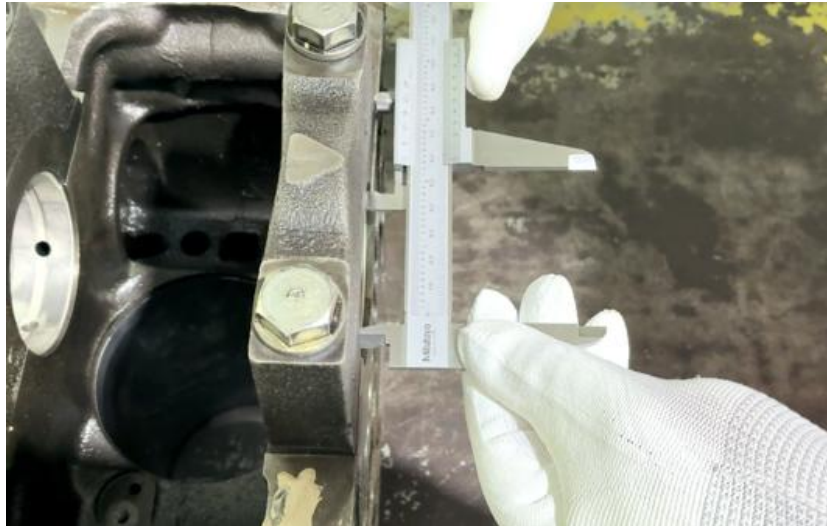
ภาพที่ 5.12 การตรวจวัดความโตภายในเบื้องต้นของลูกปืนข้อหลักเพลาค้อเหวี่ยง (ที่มา : เดช ทองแก้ว, 2567)
