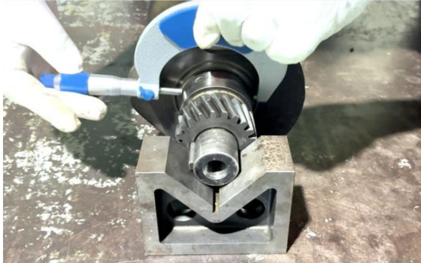
ภาพที่ 5.28 การตรวจวัดความโตข้อหลักเพลาค้อเหวี่ยงข้อที่ 1 ในแนวที่ 2 จุดการตรวจวัดตำแหน่งที่ 2 (ที่มา : เดช ทองแก้ว, 2567)
