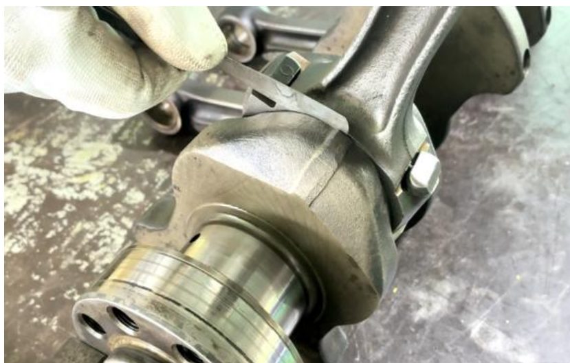
ภาพที่ 5.77 การตรวจวัดระยะห่างด้านข้างก้านสูบกับข้างแก้มข้อก้านสูบเพลาคือเหวี่ยงเครื่องยนต์สูบที่ 4 (ที่มา : เศษ ทองแก้ว, 2567)
