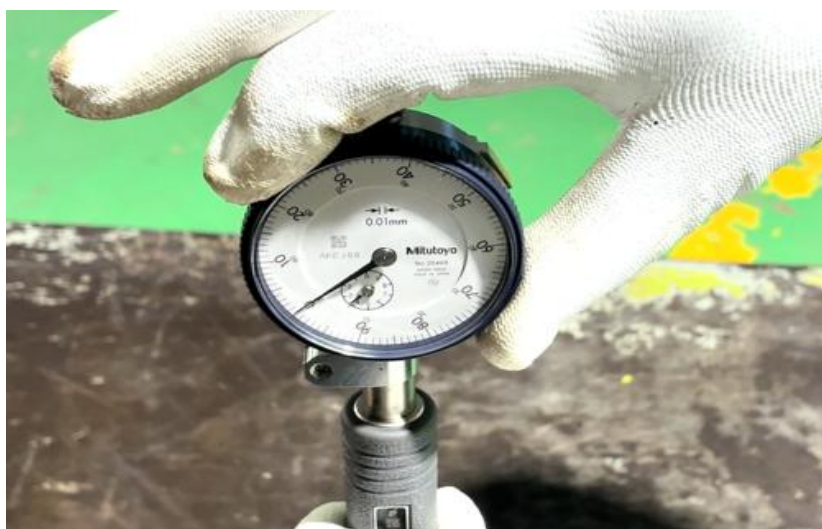
ภาพที่ 5.18 การปรับเกจหน้าปิดเกจวัดกระบอกสูบให้เข็มยาวตรงกับสเกล “0” เพื่อให้ขนาด เกจวัดกระบอกสูบมีค่าเท่ากับไมโครมิเตอร์ (ที่มา : เดช ทองแก้ว, 2567)
