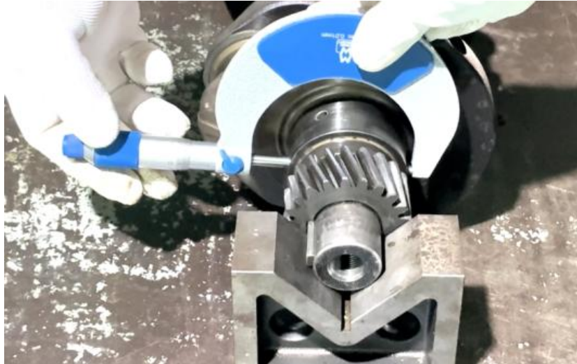
ภาพที่ 5.26 การตรวจวัดความโตข้อหลักเพลาข้อเหวี่ยงข้อที่ 1 ในแนวที่ 2 จุดการตรวจวัดตำแหน่งที่ 1 (ที่มา : เดช ทองแก้ว, 2567)
