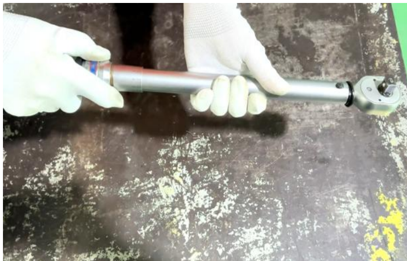
ภาพที่ 5.7 การทำความสะอาดและตรวจสอบความสมบูรณ์ของประแจวัดแรงบิด (ที่มา : เดช ทองแก้ว, 2567)
