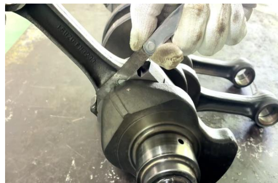
ภาพที่ 5.60 การตรวจวัดระยะห่างด้านข้างก้านสูบเครื่องยนต์ (ที่มา : เดช ทองแก้ว, 2567)
