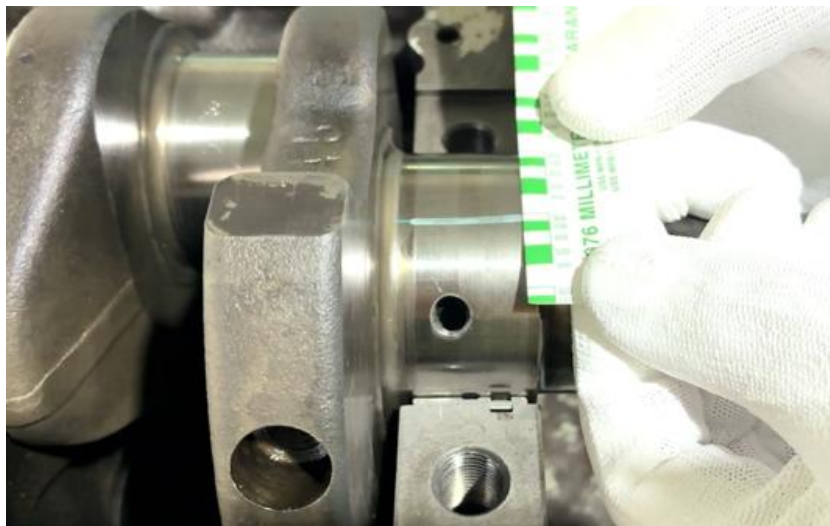
ภาพที่ 5.79 การตรวจวัดระยะช่องว่างน้ำมันข้อหลักกับลูกปืนข้อหลักเพลาค้อเหวี่ยงเครื่องยนต์ (ที่มา : เดช ทองแก้ว, 2567)
