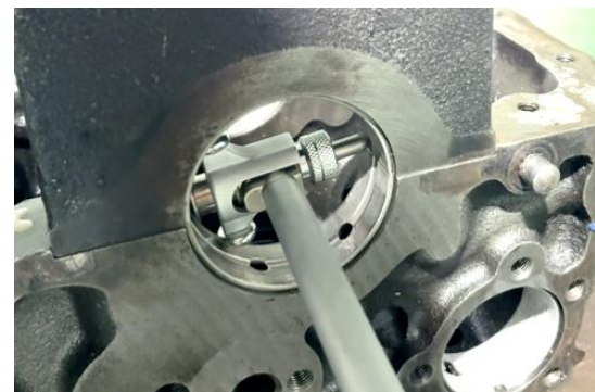
ภาพที่ 5.3 การตรวจวัดความโตภายในลูกปืนข้อหลักเพลาค้อเหวี่ยงเครื่องยนต์ (ที่มา : เดช ทองแก้ว, 2567)
