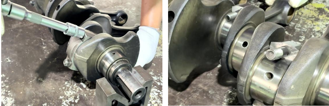
ภาพที่ 5.95 การคลายโบลท์ยึดฝาประกบข้อก้านสูบ และนำฝาประกบข้อก้านสูบออกจากเพลาค้อเหวี่ยงเครื่องยนต์ (ที่มา : เดช ทองแก้ว, 2567)
