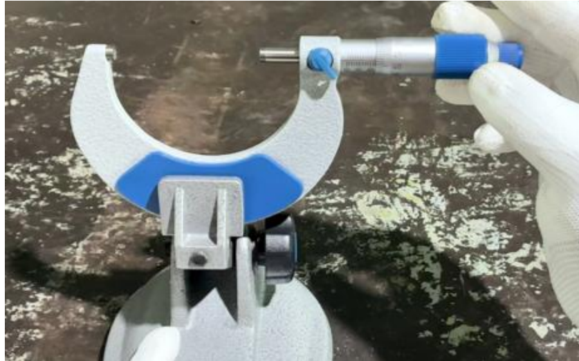
ภาพที่ 5.43 การปรับตั้งค่าไมโครมิเตอร์ให้ได้ระยะวัดเท่ากับหรือใกล้เคียงค่าความโตภายใน ลูกปืนข้อก้านสูบเพลาคือเหวี่ยง (ที่มา : เดช ทองแก้ว, 2567)
