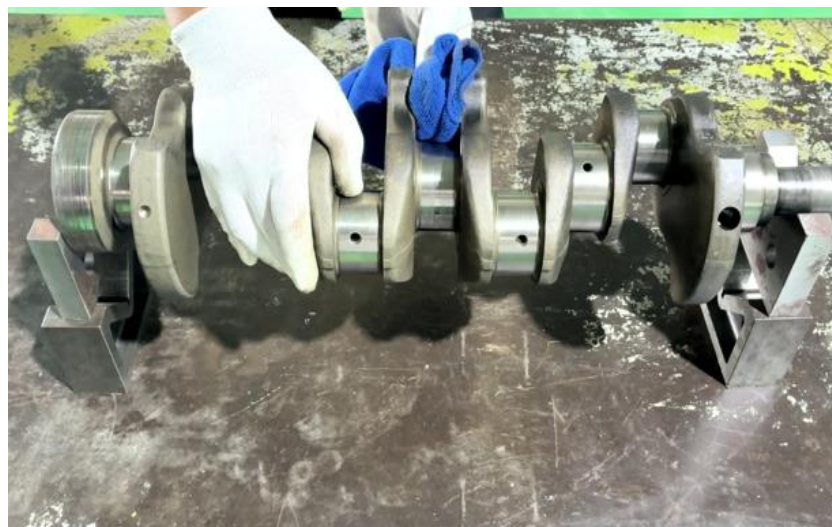
ภาพที่ 5.38 การทำความสะอาดเพลาคอเหวี่ยงเครื่องยนต์และวางลงในแท่นรองรับแบบปากตัววี (ที่มา : เดช ทองแก้ว, 2567)
