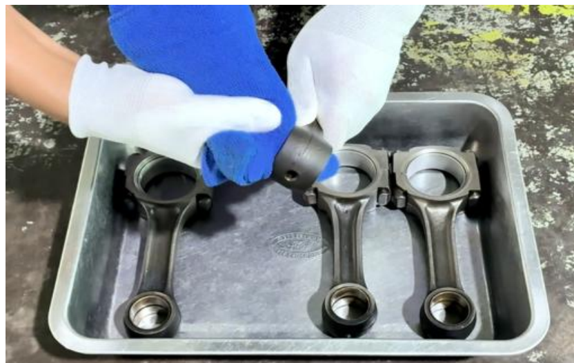
ภาพที่ 5.104 การทำความสะอาดบูชก้านสูบเครื่องยนต์ (ที่มา : เดช ทองแก้ว, 2567)
