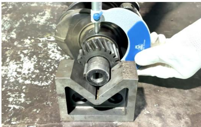
ภาพที่ 5.25 การตรวจวัดความโตข้อหลักเพลาข้อเหวี่ยงข้อที่ 1 ในแนวที่ 1 จุดการตรวจวัดตำแหน่งที่ 1 (ที่มา : เดช ทองแก้ว, 2567)
