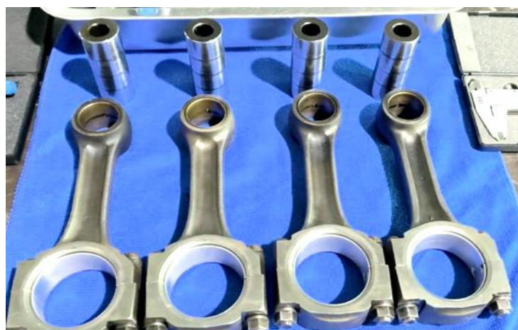
ภาพที่ 5.102 ชิ้นส่วนเครื่องยนต์ในการปฏิบัติงานตรวจวัดระยะห่างสลักลูกสูบกับบูชก้านสูบเครื่องยนต์ (ที่มา : เดช ทองแก้ว, 2567)
