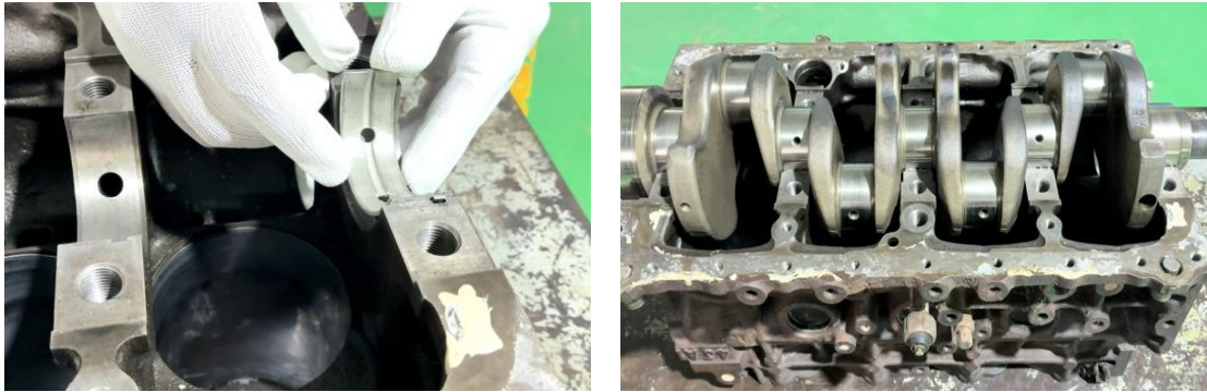
ภาพที่ 5.85 การติดตั้งเพลาค้อเหวี่ยงเข้ากับเสื้อสูบเครื่องยนต์ (ที่มา : เดช ทองแก้ว, 2567)
