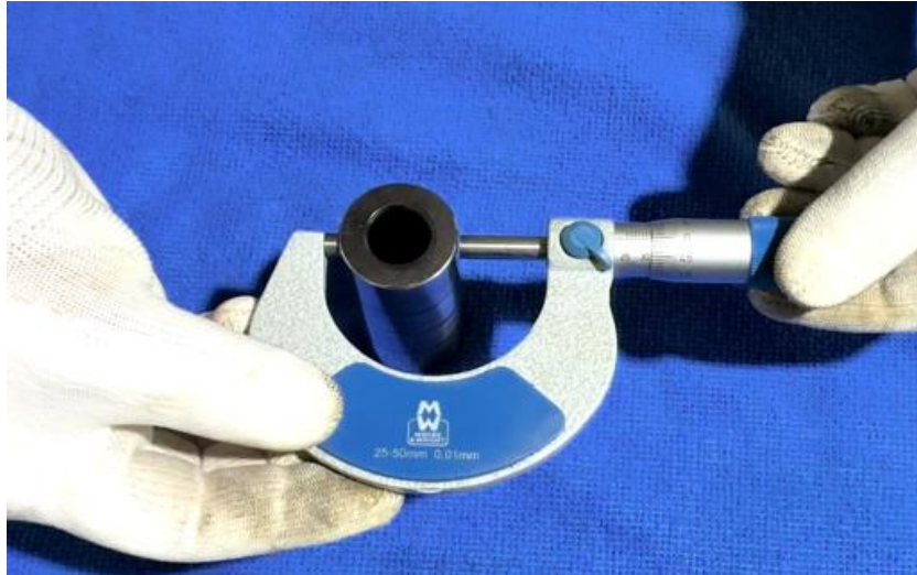
ภาพที่ 5.115 การตรวจวัดความโตสลักลูกสูบเครื่องยนต์สูบที่ 1 จุดการตรวจวัดตำแหน่งที่ 1 แนวที่ 1 (ที่มา : เดช ทองแก้ว, 2567)
