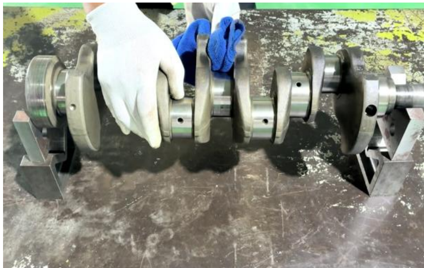
ภาพที่ 5.84 การทำความสะอาดข้อหลักและข้อก้านสูบเพลาข้อเหวี่ยงเครื่องยนต์ (ที่มา : เดช ทองแก้ว, 2567)
