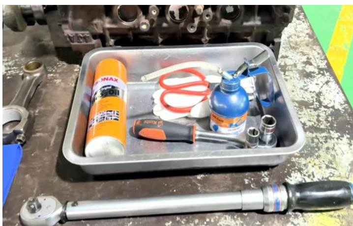
ภาพที่ 5.81 เครื่องมือวัดละเอียด วัสดุ และอุปกรณ์ในการปฏิบัติงานตรวจวัดระยะช่องว่างน้ำมันเพลาค้อเหวี่ยงเครื่องยนต์ (ที่มา : เดช ทองแก้ว, 2567)
