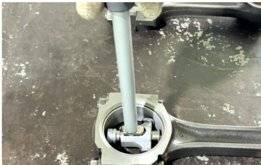
ภาพที่ 5.50 การตรวจวัดความโตภายในลูกปืนข้อก้านสูบเพลาคอเหวี่ยงสูบที่ 2 ของเครื่องยนต์ (ที่มา : เดช ทองแก้ว, 2567)
