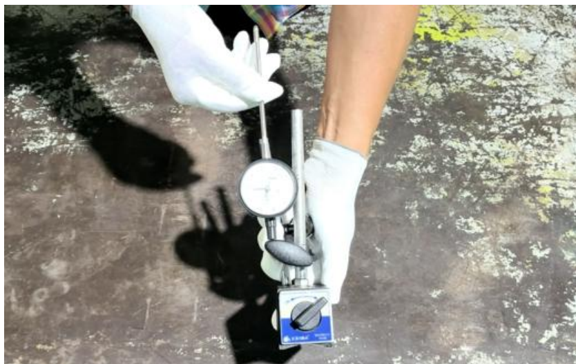
ภาพที่ 5.64 การทำความสะอาดและตรวจสอบความเที่ยงตรงของนาฬิกาวัด (ที่มา : เดช ทองแก้ว, 2567)
