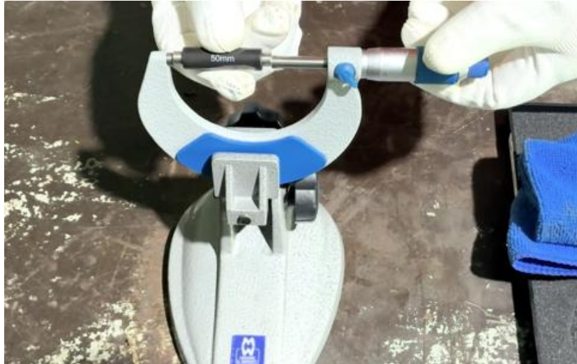
ภาพที่ 5.41 การทำความสะอาดและตรวจสอบความเที่ยงตรงของไมโครมิเตอร์วัดนอก (ที่มา : เดช ทองแก้ว, 2567)
