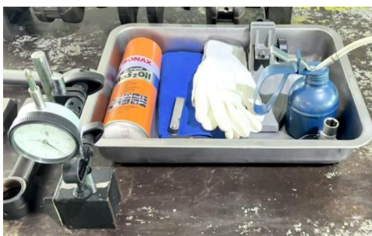
ภาพที่ 5.62 เครื่องมือวัดละเอียด วัสดุ และอุปกรณ์ในการปฏิบัติงานตรวจวัดการคดของเพลาค้อเหวี่ยง และระยะห่างด้านข้างก้านสูบเครื่องยนต์ (ที่มา : เดช ทองแก้ว, 2567)
