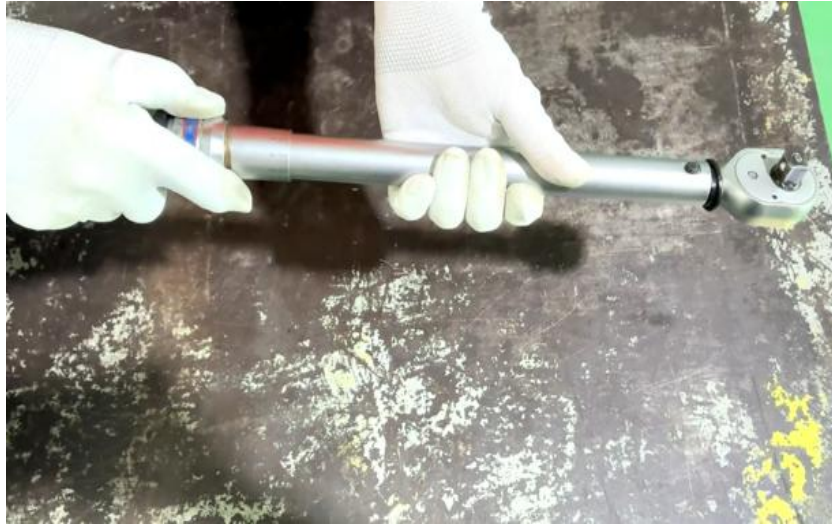
ภาพที่ 5.83 การทำความสะอาดและตรวจสอบความสมบูรณ์ของประแจวัดแรงบิด (ที่มา : เดช ทองแก้ว, 2567)
