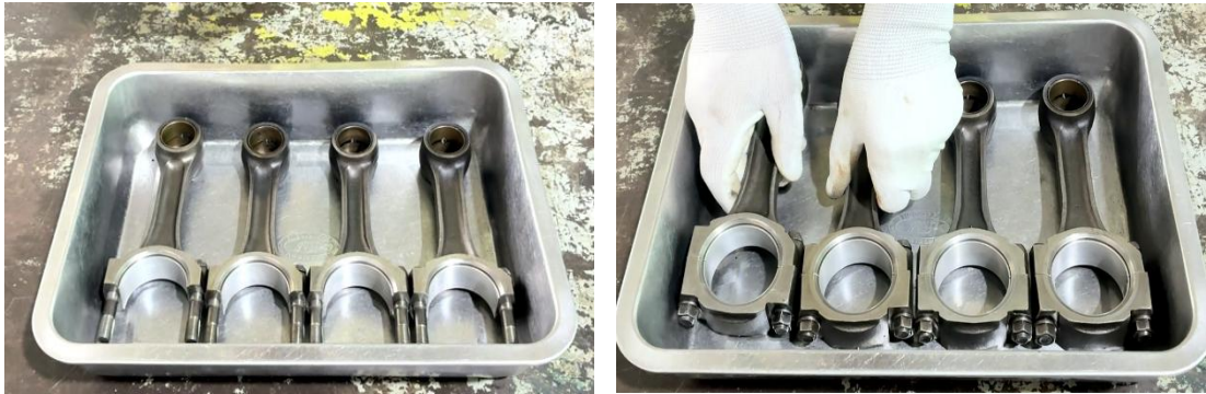
ภาพที่ 5.37 การประกอบลูกปืนพร้อมฝาประกบเข้ากับก้านสูบเครื่องยนต์ (ที่มา : เดช ทองแก้ว, 2567)
