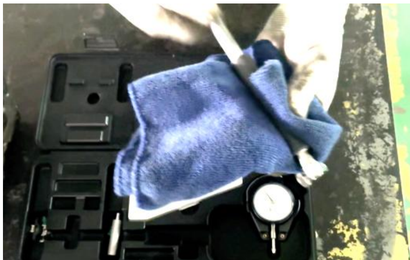
ภาพที่ 5.42 การทำความสะอาดและตรวจสอบสภาพความสมบูรณ์ของเกจวัดกระบอกสูบ (ที่มา : เดช ทองแก้ว, 2567)
