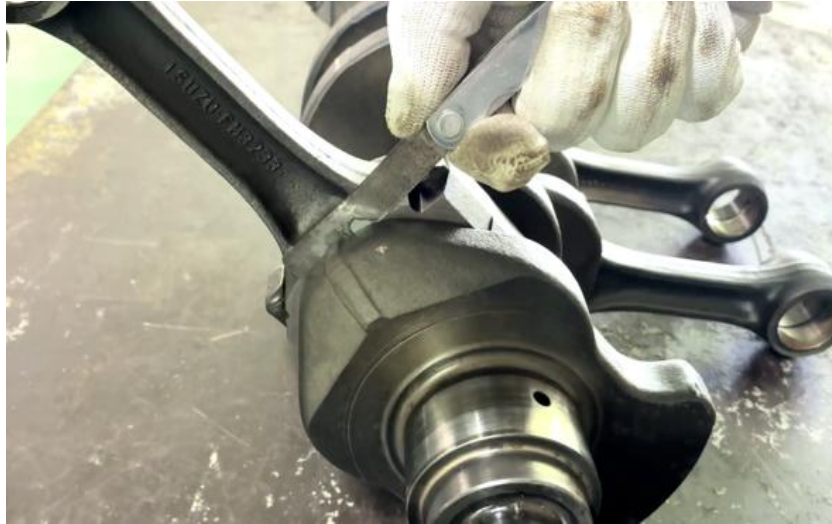
ภาพที่ 5.73 การตรวจวัดระยะห่างด้านข้างก้านสูบกับข้างแก้มข้อก้านสูบเพลาคือเหวี่ยงเครื่องยนต์สูบที่ 1 ด้านซ้ายของก้านสูบ (ที่มา : เดช ทองแก้ว, 2567)
