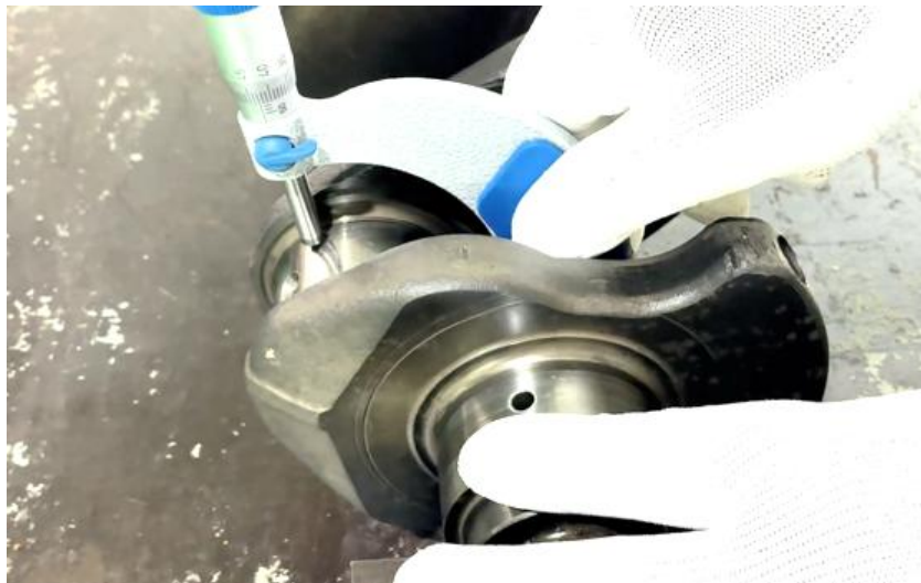
ภาพที่ 5.56 การตรวจวัดความโตของก้านสูบเพลาคือเหียงสูบที่ 1 แนวที่ 2 จุดการตรวจวัดตำแหน่งที่ 2 (ที่มา : เดช ทองแก้ว, 2567)
