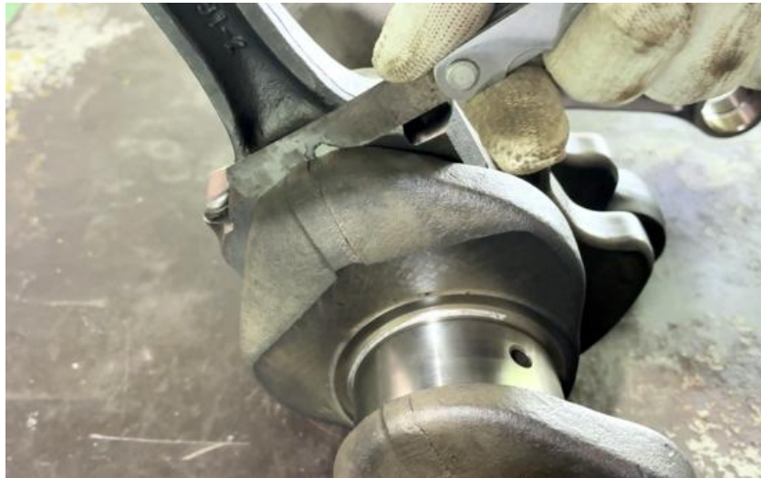
ภาพที่ 5.75 การตรวจวัดระยะห่างด้านข้างก้านสูบกับข้างแก้มข้อก้านสูบเพลาคือเหวี่ยงเครื่องยนต์สูบที่ 2 (ที่มา : เดช ทองแก้ว, 2567)
