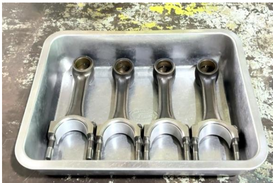
ภาพที่ 5.72 การประกอบลูกปืนเข้ากับก้านสูบและขันโบลท์ยึดฝาประกบก้านสูบเครื่องยนต์ (ที่มา : เดช ทองแก้ว, 2567)
