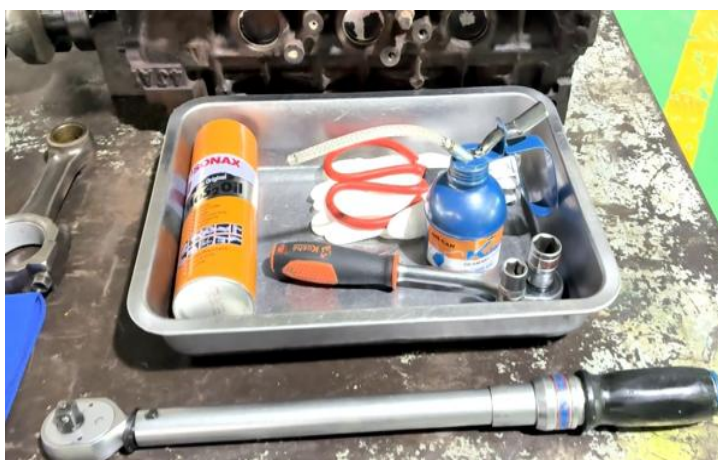
ภาพที่ 5.82 เครื่องมือวัดละเอียด วัสดุ และอุปกรณ์ในการปฏิบัติงานตรวจวัดระยะช่องว่างน้ำมันเพลาค้อเหวี่ยงเครื่องยนต์ (ที่มา : เดช ทองแก้ว, 2567)
