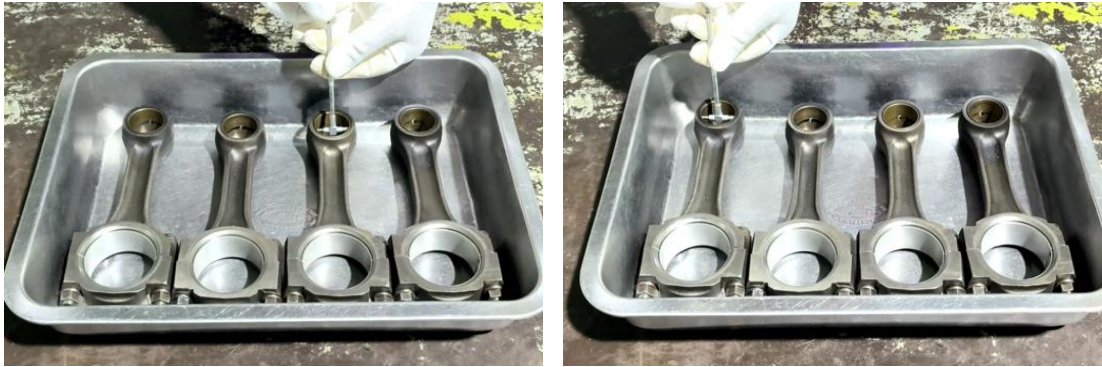
ภาพที่ 5.113 การตรวจวัดความโตของก้านสูบเครื่องยนต์สูบที่ 2, 3 และ 4 (ที่มา : เดช ทองแก้ว, 2567)
