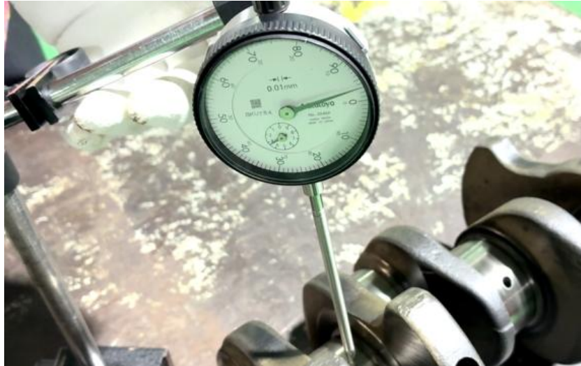
ภาพที่ 5.69 การปรับนาฬิกาวัดก่อนตรวจวัดการคดของเพลาข้อเหวี่ยงเครื่องยนต์ (ที่มา : เดช ทองแก้ว, 2567)
