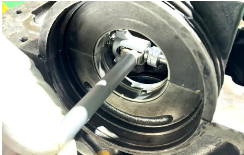
ภาพที่ 5.24 การตรวจวัดความโตภายในลูกปืนข้อหลักเพลาข้อเหวี่ยงข้อที่ 2, 3, 4 และ 5 ของเสื้อสูบเครื่องยนต์ (ที่มา : เดช ทองแก้ว, 2567)
