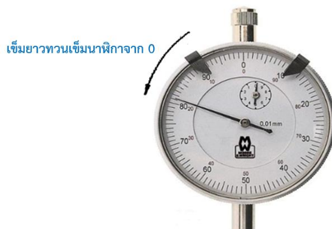
ภาพที่ 5.48 การอ่านค่าความโตภายในลูกปืนข้อก้านสูบเพลาคอเหวี่ยง (ที่มา : เดช ทองแก้ว, 2567)
