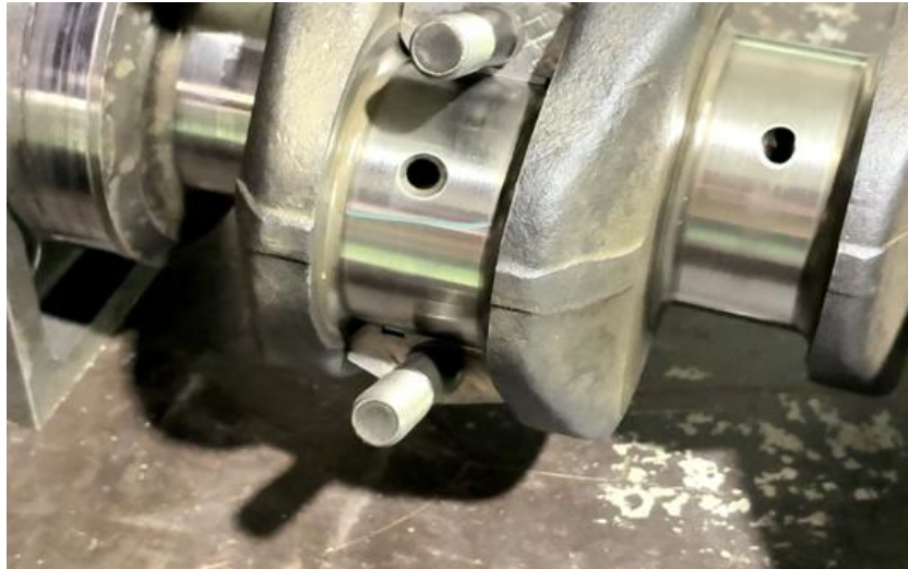
ภาพที่ 5.93 การติดพลาสติกเกจเข้ากับข้อก้านสูบเพลาคอเหวี่ยงเครื่องยนต์ (ที่มา : เดช ทองแก้ว, 2567)
