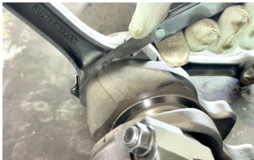
ภาพที่ 5.76 การตรวจวัดระยะห่างด้านข้างก้านสูบกับข้างแก้มข้อก้านสูบเพลาคือเหวี่ยงเครื่องยนต์สูบที่ 3 (ที่มา : เดช ทองแก้ว, 2567)
