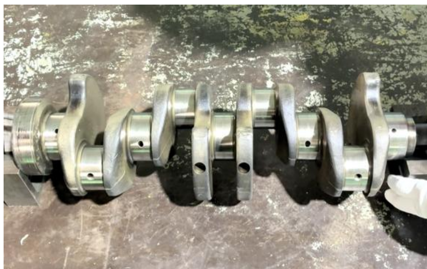
ภาพที่ 5.90 การวางเพลาค้อเหวี่ยงเครื่องยนต์ลงในแท่นรองรับแบบปากตัววี (ที่มา : เดช ทองแก้ว, 2567)
