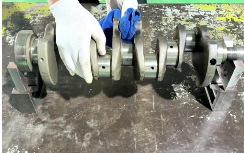
ภาพที่ 5.63 การทำความสะอาดเพลาค้อเหวี่ยงเครื่องยนต์และวางลงในแท่นรองรับแบบปากตัววี (ที่มา : เดช ทองแก้ว, 2567)
