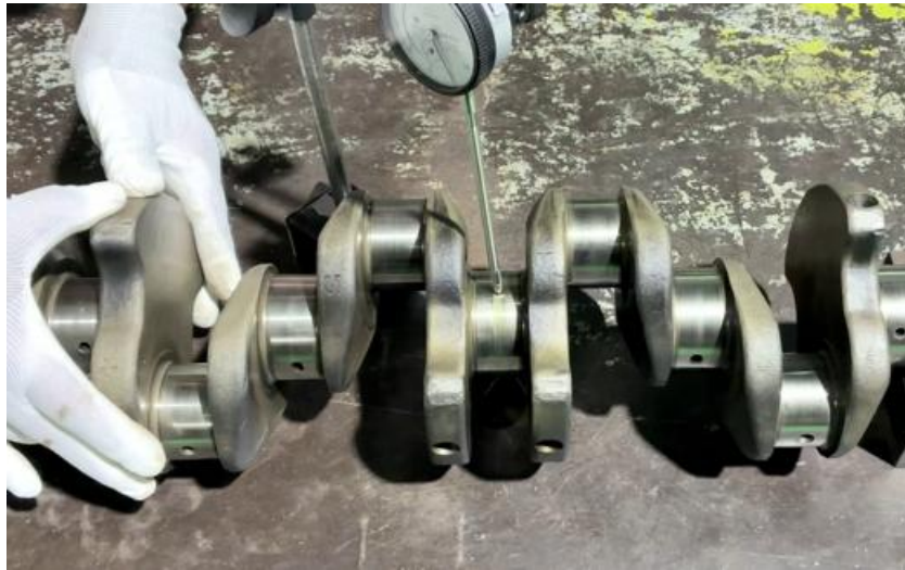
ภาพที่ 5.71 อ่านค่าการคดของเพลาคอเหวี่ยงเครื่องยนต์จากนาฬิกาวัด (ที่มา : เดช ทองแก้ว, 2567)
