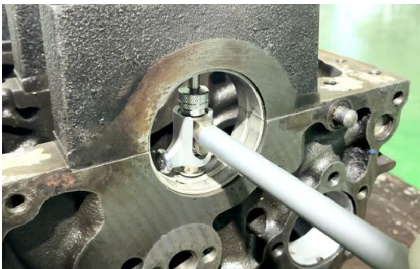
ภาพที่ 5.22 การตรวจวัดความโตภายในลูกปืนข้อหลักเพลาคอเหวี่ยงข้อที่ 1 ของเสื้อสูบเครื่องยนต์ แนวที่ 1 จุดตรวจวัดตำแหน่งที่ 2 (ที่มา : เดช ทองแก้ว, 2567)
