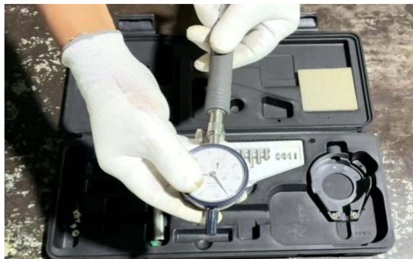
ภาพที่ 5.44 การประกอบเกจวัดกระบอกสูบเพื่อตรวจวัดความโตลูกปืนข้อก้านสูบเพลาคือเหวี่ยง (ที่มา : เดช ทองแก้ว, 2567)
