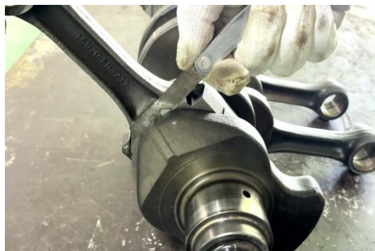
ภาพที่ 5.58 การคดของเพลาค้อนเหวี่ยงและระยะห่างด้านข้างก้านสูบเครื่องยนต์ (ที่มา : เดช ทองแก้ว, 2567)
