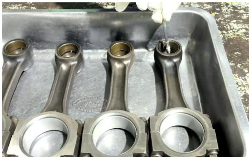
ภาพที่ 5.112 การตรวจวัดความโตบูชก้านสูบเครื่องยนต์สูบที่ 1 (ที่มา : เดช ทองแก้ว, 2567)
