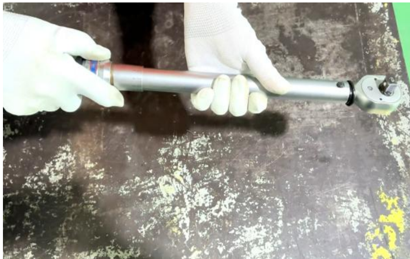
ภาพที่ 5.66 การทำความสะอาดและตรวจสอบความสมบูรณ์ของประแจวัดแรงบิด (ที่มา : เดช ทองแก้ว, 2567)
