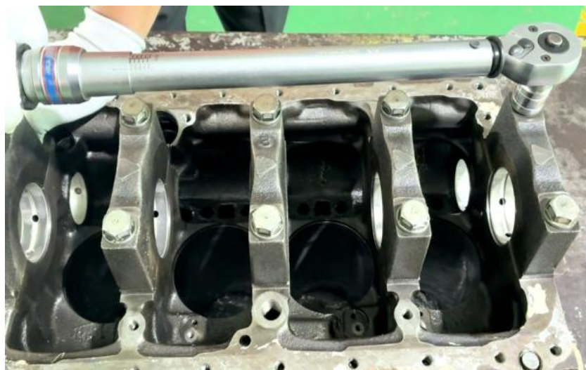
ภาพที่ 5.9 การชนโบลที่ยึดฝาประกับข้อหลักเพลาคอเหวี่ยงเครื่องยนต์ (ที่มา : เดช ทองแก้ว, 2567)
