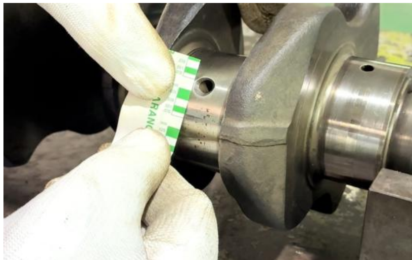
ภาพที่ 5.96 การเทียบความกว้างที่ได้กับค่ามาตรฐานความกว้างของพลาสติกเกจที่ถูกบีบอัด (ที่มา : เดช ทองแก้ว, 2567)
