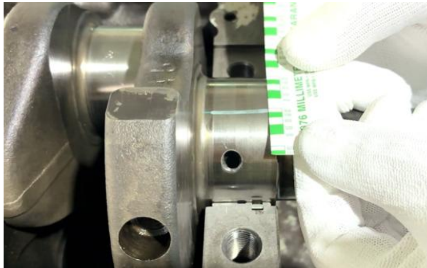
ภาพที่ 5.89 การเทียบความกว้างที่ได้กับค่ามาตรฐานความกว้างของพลาสติกเกจที่ถูกบีบอัด (ที่มา : เดช ทองแก้ว, 2567)
