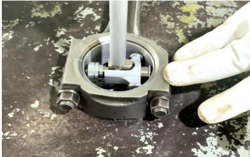
ภาพที่ 5.49 การตรวจวัดความโตภายในลูกปืนข้อก้านสูบเพลาคอเหวี่ยงสูบที่ 1 ของเครื่องยนต์แนวที่ 2 (ที่มา : เดช ทองแก้ว, 2567)
