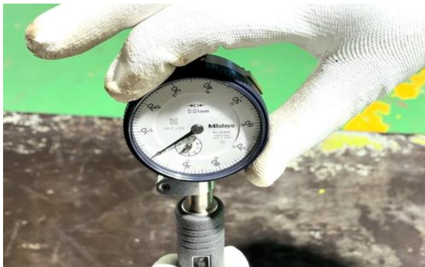
ภาพที่ 5.46 การปรับเก็หน้าปิดเกจวัดกระบอกสูบให้เข็มยาวตรงกับสเกล “0” เพื่อให้ขนาดเกจวัดกระบอกสูบมีค่าเท่ากับไมโครมิเตอร์ (ที่มา : เดช ทองแก้ว, 2567)
