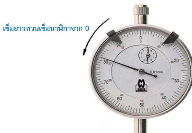
ภาพที่ 5.20 การอ่านค่าความโตภายในลูกปืนข้อหลักเพลาคอเหวี่ยง (ที่มา : เดช ทองแก้ว, 2567)
