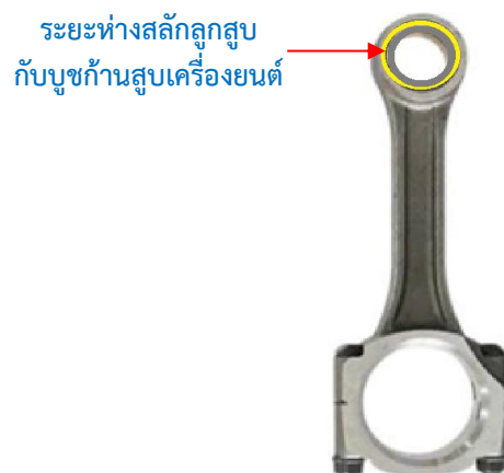
ภาพที่ 5.100 ระยะห่างสลักลูกสูบกับบุชก้านสูบเครื่องยนต์ (ที่มา : เดช ทองแก้ว, 2567)
