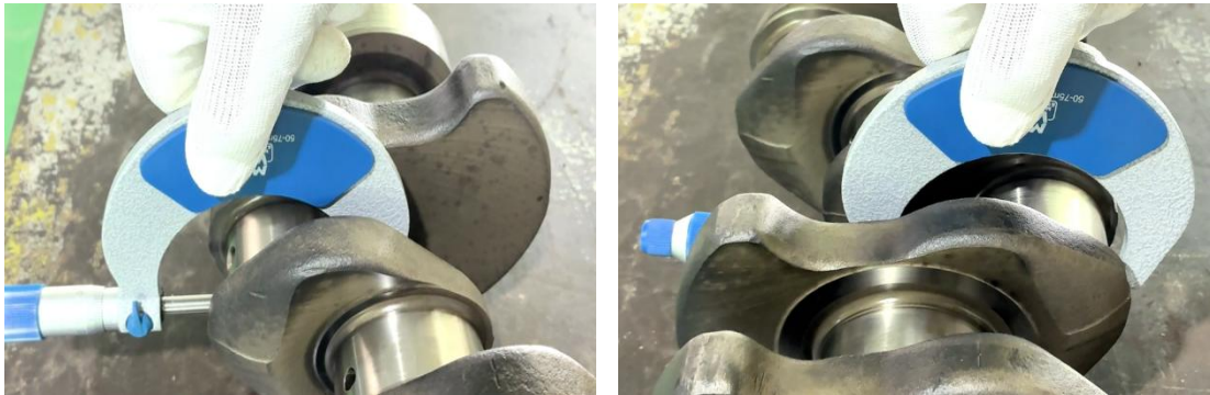
ภาพที่ 5.57 การตรวจวัดความโตของก้านสูบเพลาคือเหียงสูบที่ 2, 3, และ 4 (ที่มา : เดช ทองแก้ว, 2567)
