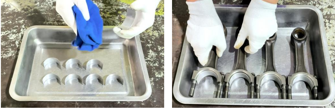
ภาพที่ 5.91 การทำความสะอาดและประกอบลูกปืนข้อก้านสูบเพลาคอเหวี่ยงเข้ากับก้านสูบและฝาประกบกับก้านสูบเครื่องยนต์ (ที่มา : เดช ทองแก้ว, 2567)
