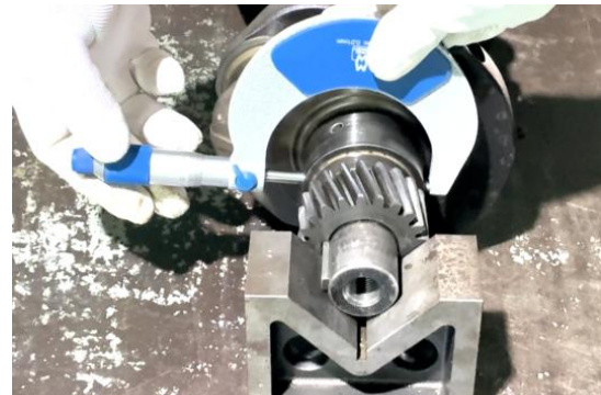
ภาพที่ 5.2 การตรวจวัดความโตข้อหลักเพลาค้อเหวี่ยงเครื่องยนต์ (ที่มา : เดช ทองแก้ว, 2567)
